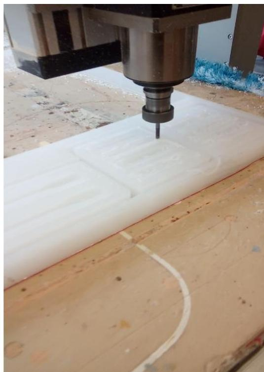
Slika 5.8. Izrada kalupa
