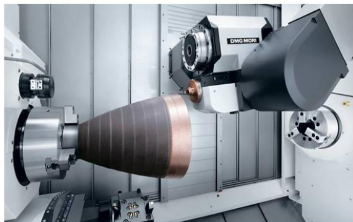
Slika 18. Obrada mlaznice rakete [19]
