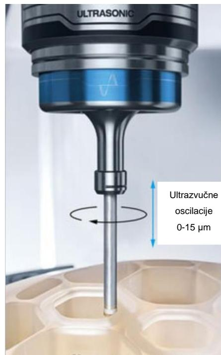
Slika 24. Ultrazvučne oscilacije [24]
