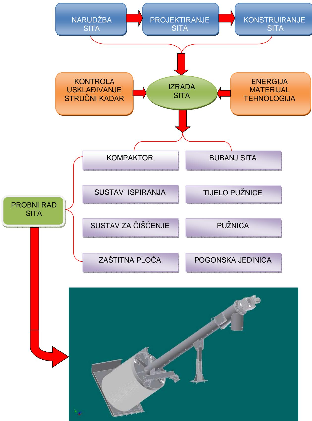
**Slika 28.** Shematski prikaz proizvodnje finog sita
