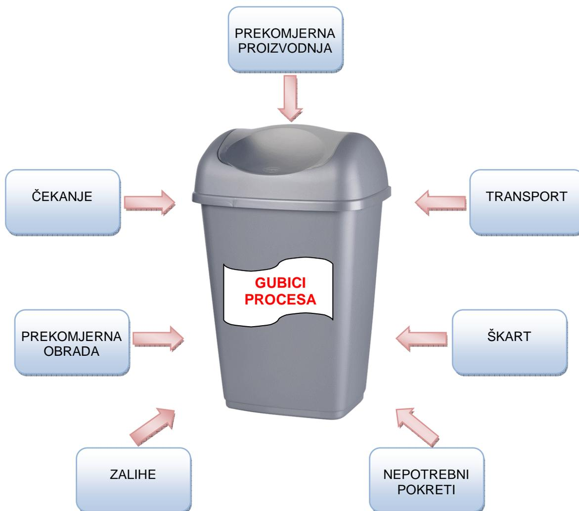
**Slika 16.** Prikaz gubitaka/rasipanja u procesu proizvodnje
