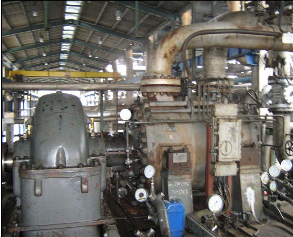
Slika 4.3 Centrifugalni kompresor za transport vodika 301-MC-1 [8]
