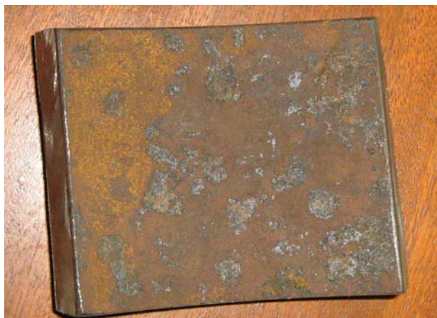
Slika 5.1 Reprezentativni uzorak cjevovoda za izradu epruveta za ispitivanje žilavosti i za metalografska ispitivanja
