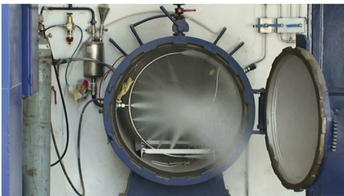
Slika 2.13 Potpuno raspršivanje uzorka prašne u kotlu volumena  $1 \text{ m}^3$  [12]
