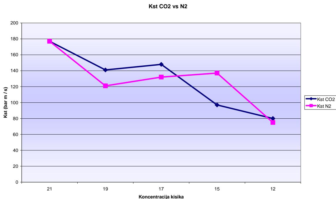
Slika 6.1 Uporedba vrijednosti  $K_{St}$ -a u ovisnosti o inertnom plinu
