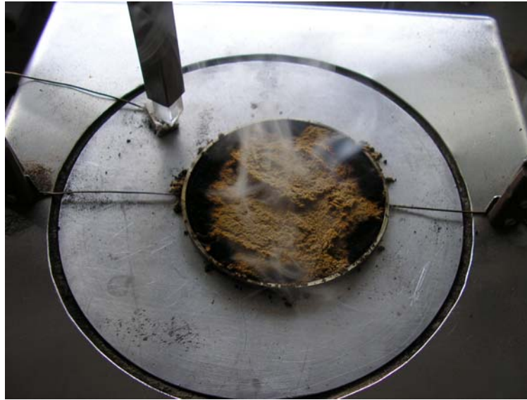
Slika 2.2 Početak tinjanja drvene prašine [12]
