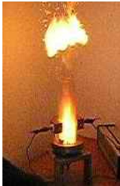
Slika 2.8 Zapaljeni uzorak prašine tijekom ispitivanja [12]
