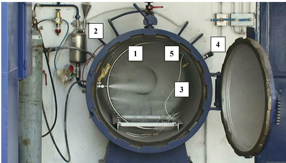
Slika 2.12 Prikaz početka raspršivanja uzorka prašine u kotlu volumena  $1 \text{ m}^3$  [12]
