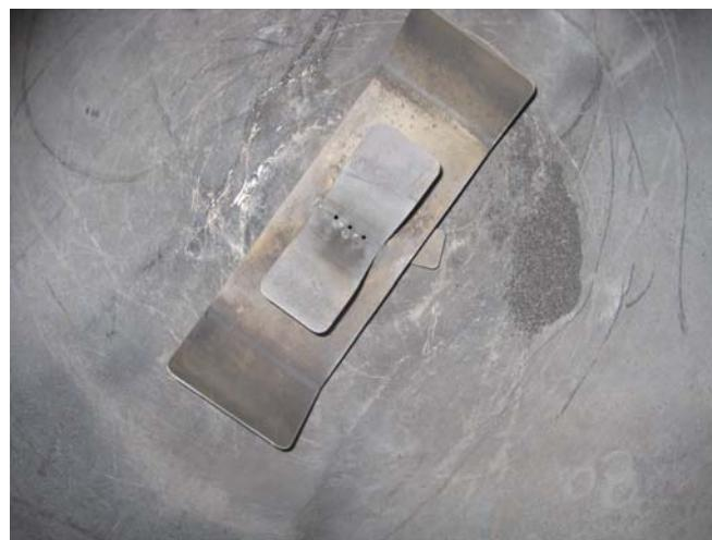
Slika 4.13 Mlaznica za raspršivanje uzorka prašine unutar ispitne komore
