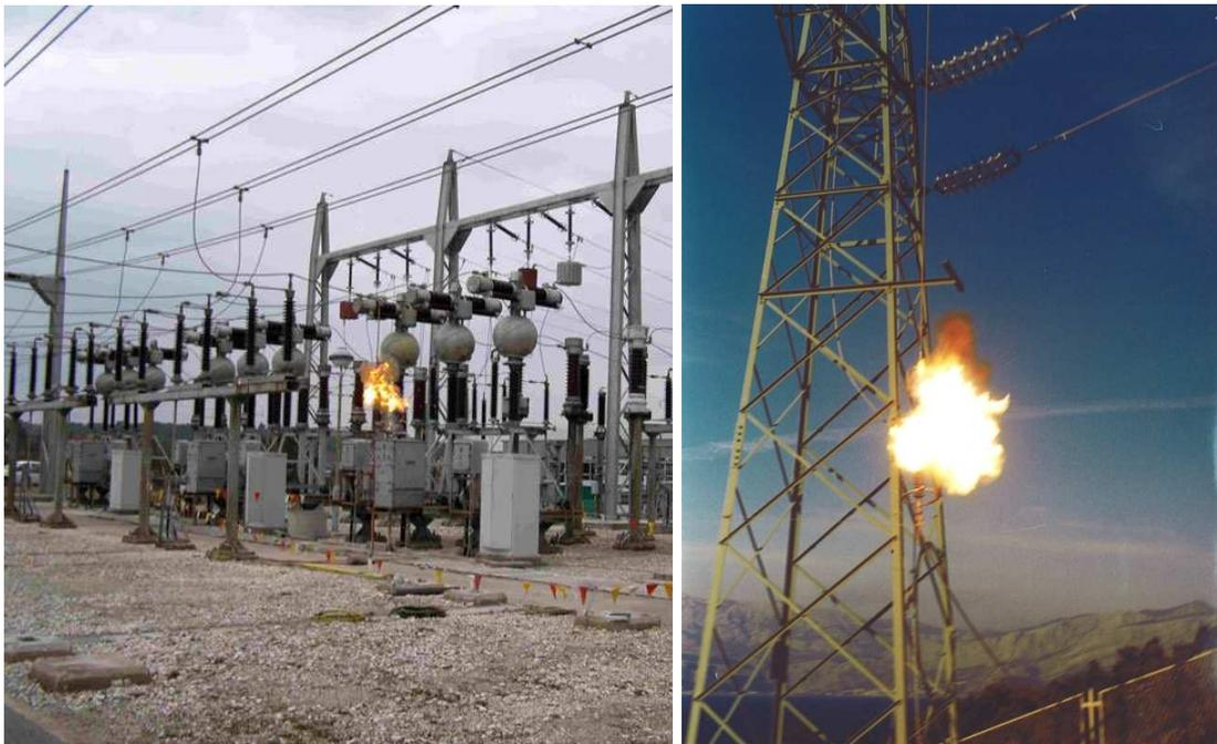
**Slika 2-4-6-4 Namjerno izazvani preskoci u postrojenju i na dalekovodu u svrhu ispitivanja (izvor: arhiva Instituta za elektroprivredu i energetiku d.d. Zagreb)**
