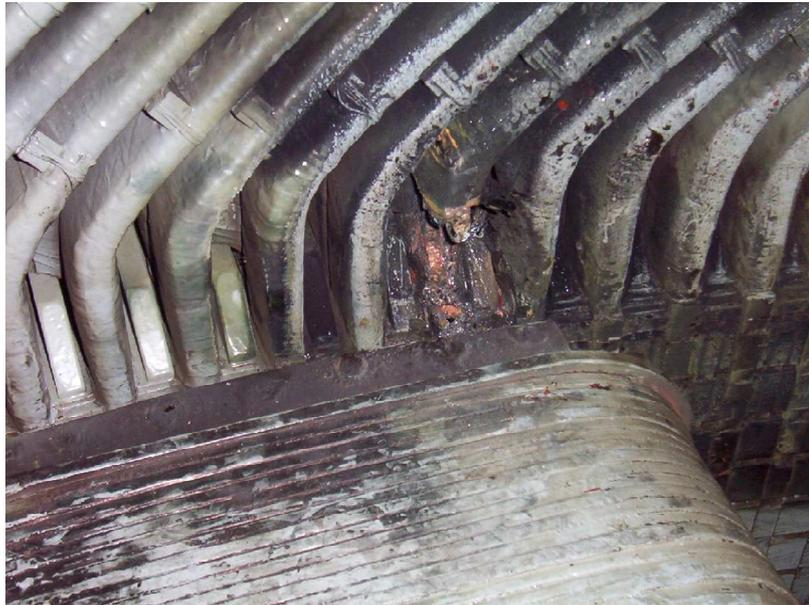
**Slika 2-4-6-3 Međuzavojni kratki spoj na namotu generatora (izvor: arhiva Instituta za elektroprivredu i energetiku d.d. Zagreb)**
