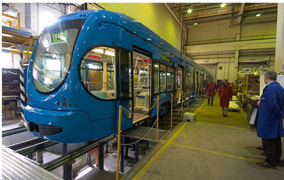
Slika 19: Konstrukcija tramvaja prije ugradnje ostalih komponenata [20]
