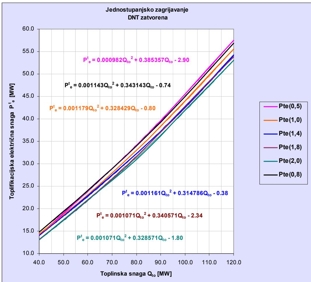
Slika 4.4. Krivulje toplifikacijskog režima rada turbine T-100-130 po toplinskome dijagramu: Funkcionalna zavisnost toplifikacijske električne snage o toplinskoj snazi oduzimanja i tlaka u nižem oduzimanju za jednostupanjsko zagrijavanje
