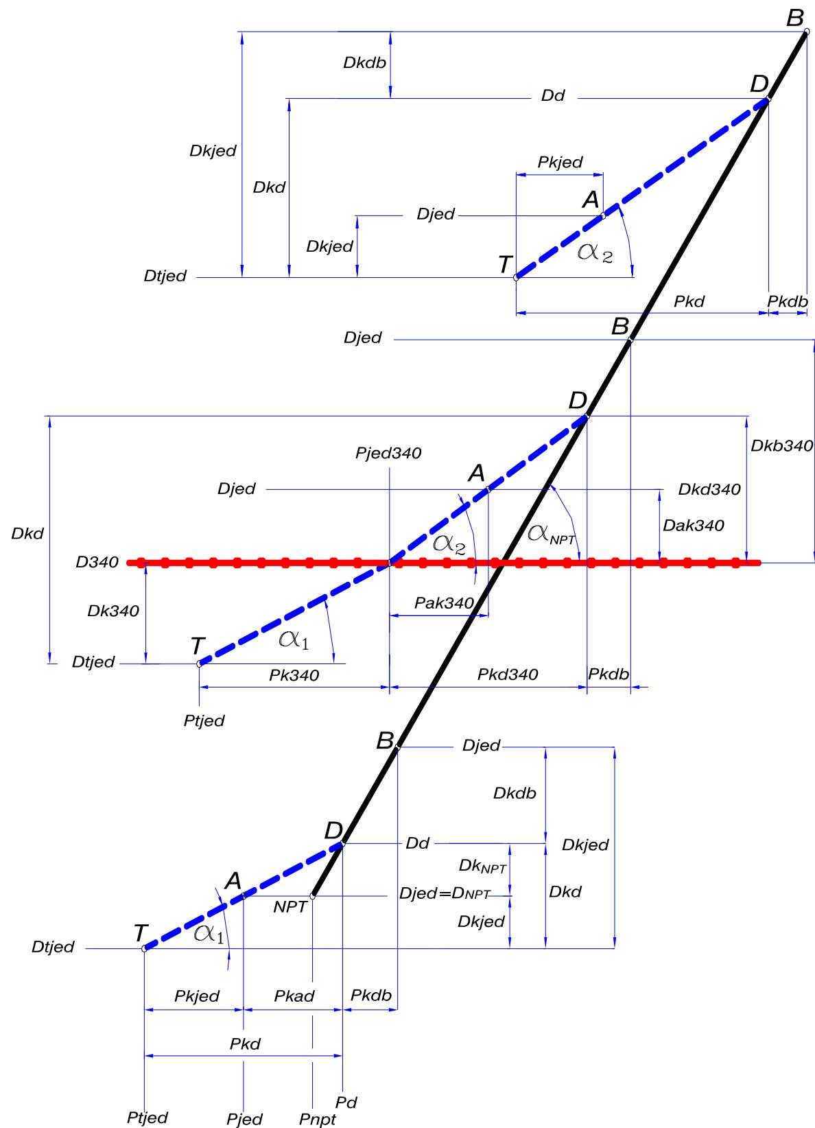
Slika 4.15. Osnovna shema za određivanje algoritma snaga i protoka u određenim područjima dijagrama režima
