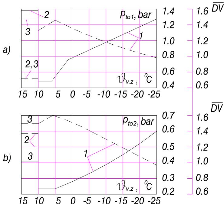
*Slika 3.2. Promjena tlaka u prostorima toplifikacijskih oduzimanja i relativna promjena volumnih protoka pare na izlazu iz predodusimnih stupnjeva tijekom godine*
