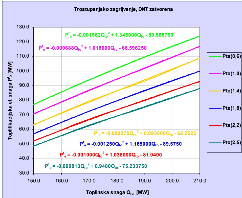
Slika 4.12. Krivulje toplifikacijskog režima rada turbine T-100-130 po toplinskem dijagramu: Funkcionalna zavisnost toplifikacijske električne snage o toplinskoj snazi i tlaku u višem toplifikacijskom oduzimanju za trostupanjsko zagrijavanje
