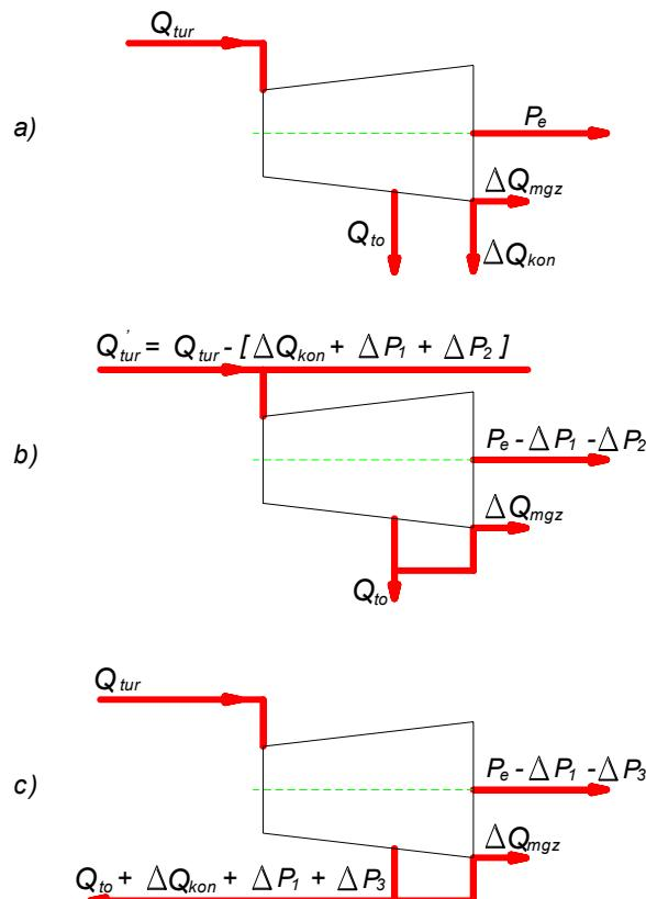
Slika 3.8. Shema osnovnih toplinskih tokova toplifikacijske turbine
