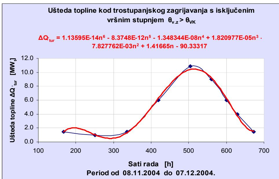
Slika 5.1. Ušteda topline kod trostupanjskog zagrijavanja s isključenim vršnim stupnjem zagrijavanja za prvi 672 sata rada (tablica 5.2)
