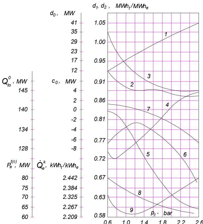
Slika 2.8. Koeficijenti jednadžbi (2.82), (2.83), (2.84) za turbinu tipa T-100/120-130-3 u zavisosti o tlaku u toplifikacijskom oduzimanju
