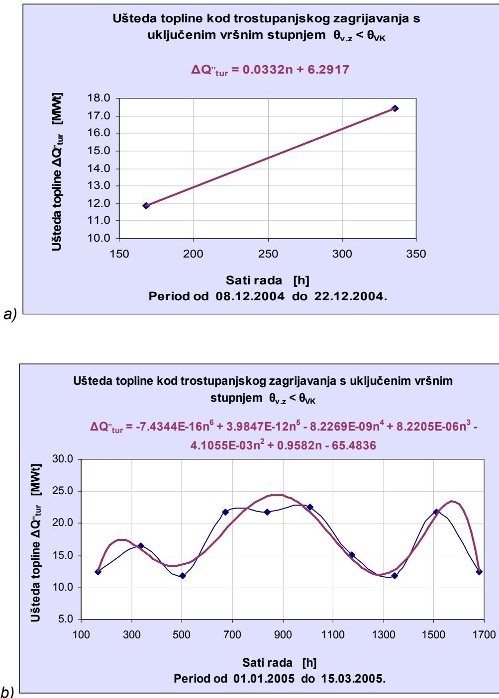
Slika 5.2. Ušteda topline kod trostupanjskog zagrijavanja s uključenim vršnim stupnjem zagrijavanja za dva perioda rada prema tablici 5.2;
