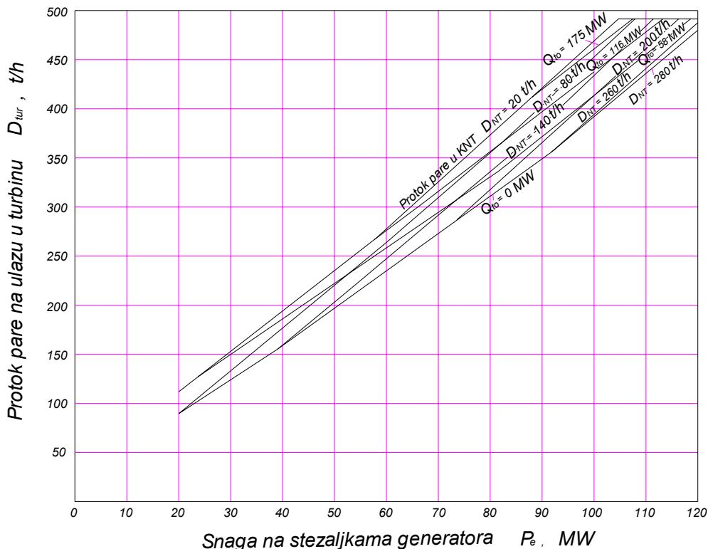
Slika 2.5a. Dijagram režima rada turbine T-100/120-130-3 s jednim toplifikacijskim oduzimanjem pare ( $p_0 = 130 \text{ bar}$ ,  $\vartheta_0 = 555^\circ\text{C}$ ,  $p_t = 1,0 \text{ bar}$ )
