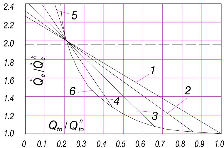
Slika 2.9. Promjena specifičnog toplinskog toka za turbinu tipa T-100-130 ( $p_0 = 130 \text{ bar}$ ,  $\vartheta_0 = 565^\circ\text{C}$ ,  $p_t = 1,2 \text{ bar}$ ) u zavisnosti o relativnom omjeru toplinskog i električnog opterećenja
