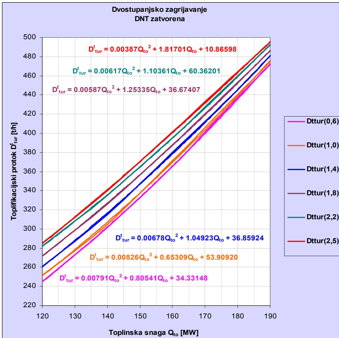
Slika 4.6. Krivulje toplifikacijskog režima rada turbine T-100-130 po toplinskom dijagramu: Funkcionalna zavisnost toplifikacijskog protoka pare o toplinskoj snazi oduzimanja i tlaka u višem oduzimanju (dvostupanjsko zagrijavanje)
