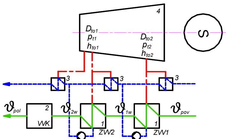
Slika 3.3. Principijelna shema stupnjevanog zagrijavanja mrežne vode
