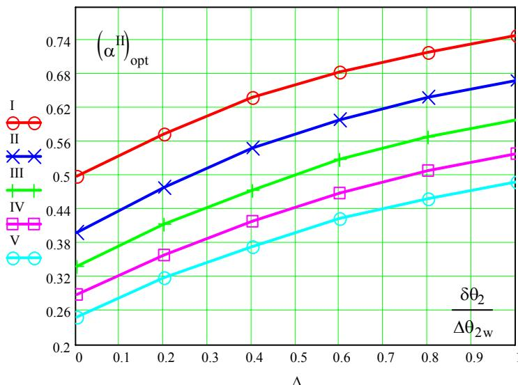
Slika 3.6. Zavisnost optimalne raspodjele toplinskog opterećenja po stupnjevima zagrijavanja mrežne vode o relativnoj veličini ukupnog pothlađenja u svakom stupnju
