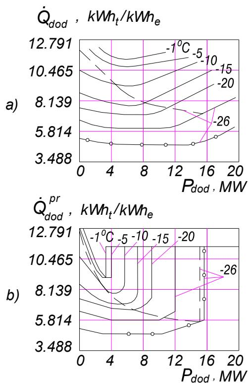
Slika 2.16. Specifična toplinski tok turbine T-100/120-130-2 za proizvodnju dodatne električne energije u zavisnosti o dodatnoj snazi
