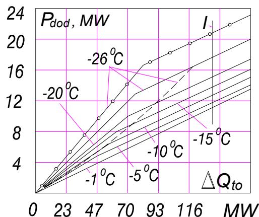
Slika 2.13. Zavisnost dodatne snage turbine T-100-130 o smanjenju toplinskog opterećenja
