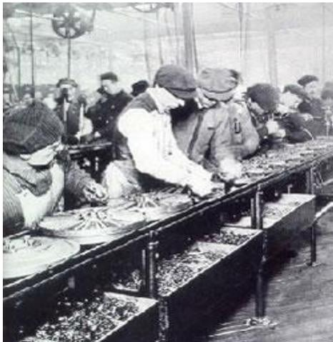
Slika 2.2. Proizvodnja i montiranje komponenti u Fordovom procesu
