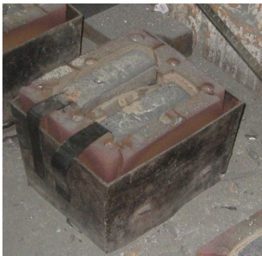
Slika 3.6. Hlađenje dviju odljevenih Y – proba u kalupu
