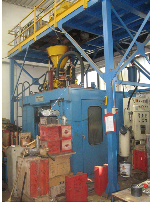
Slika 3.4. Postrojenje za izradu jezgri i kalupa postupkom Beta – set
