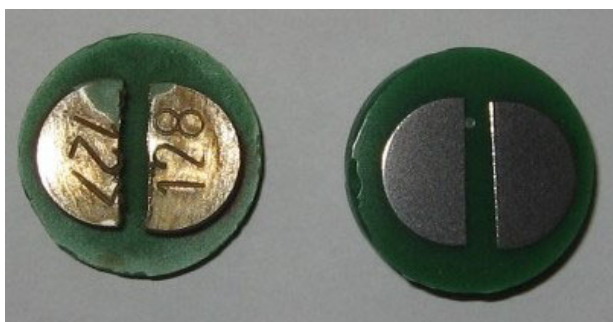
Slika 3.13. Uzorci nodularnog lijeva pripremljeni za metalografsku analizu
