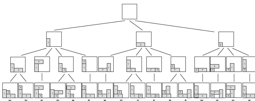
Slika 4-10: Prikaz kompleksnosti stabla kod pakiranja tri različita elemenata u posudu (bez oktogonalne rotacije elemenata)
