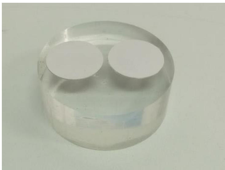
Slika 29: Ispolirani i očišćeni uzorci prije elektrokemijskog ispitivanja
