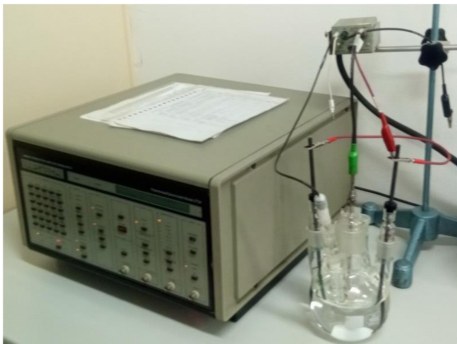
Slika 26: Potenciostat i elektrokemijska ćelija korišteni za laboratorijska ispitivanja
