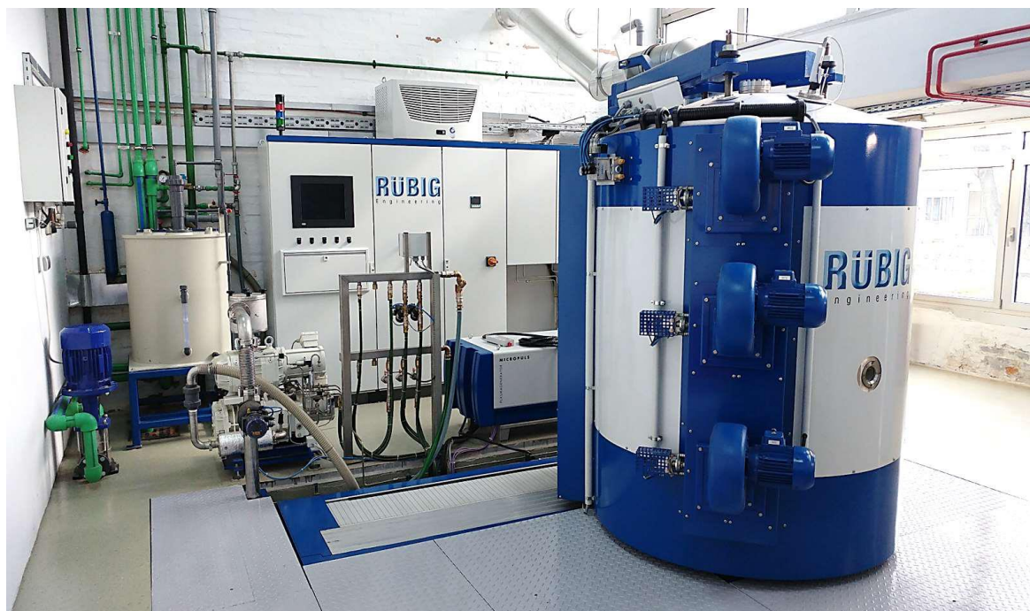
Slika 5.47 Uređaj za PACVD prevlačenje Rübige PC 70/90
