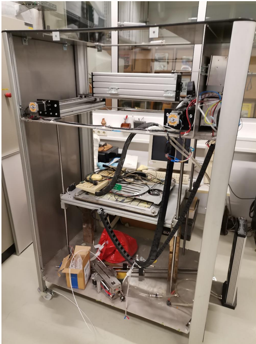
Slika 14. 3D pisač velikog radnog volumena
