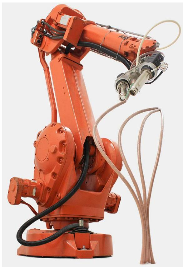
Slika 11. Primjena robotske ruke u FDM procesu [14]
