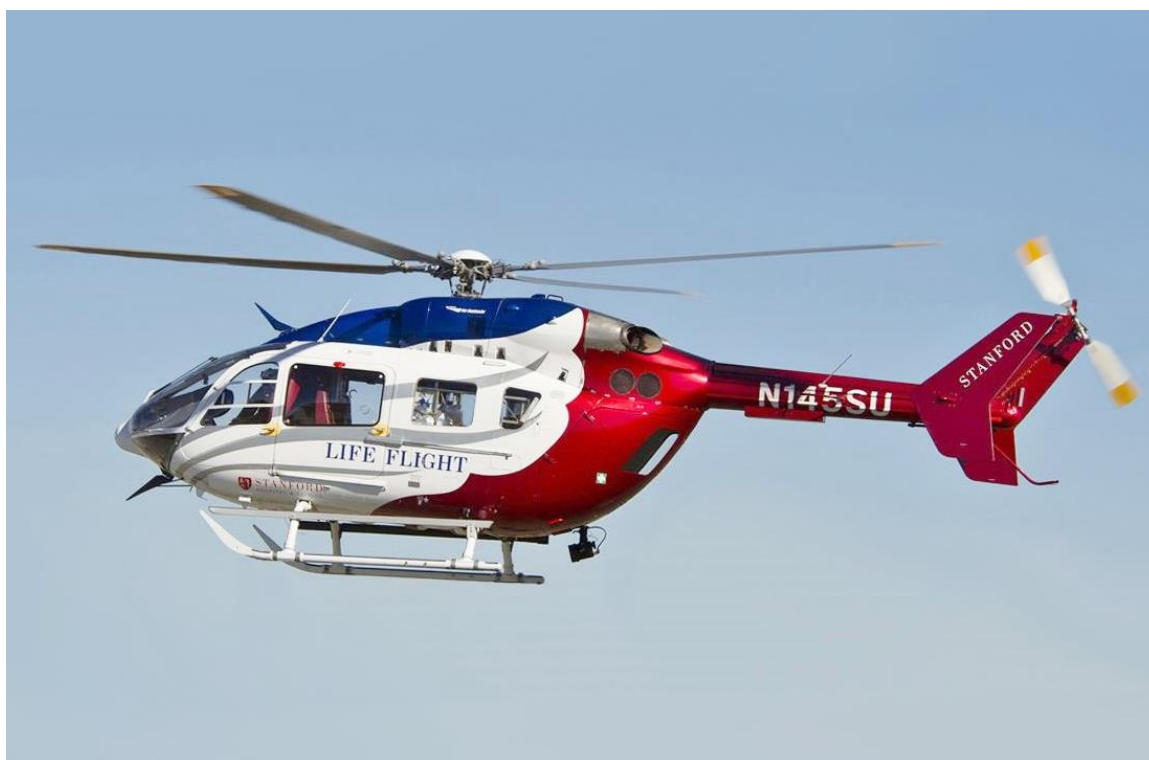
Slika 1.2. Primjer helikoptera s konvencionalnim repnim rotorom [3]
