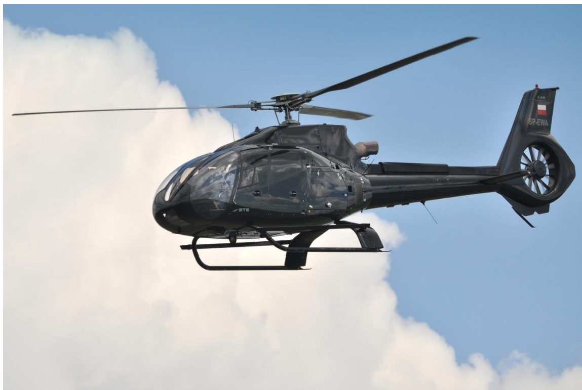
Slika 1.1. Primjer helikoptera s Fenestron repnim rotorom [2]
