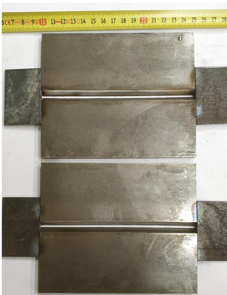
Slika 5.8 Pripremljeni uzorci B-1 i B-2 za postupak zavarivanja
