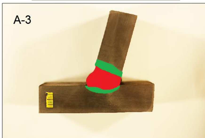
Slika 5.30 Zone/područja zavara vidljive na makruizbrusku uzoraka A-1, A-2 i A-3
