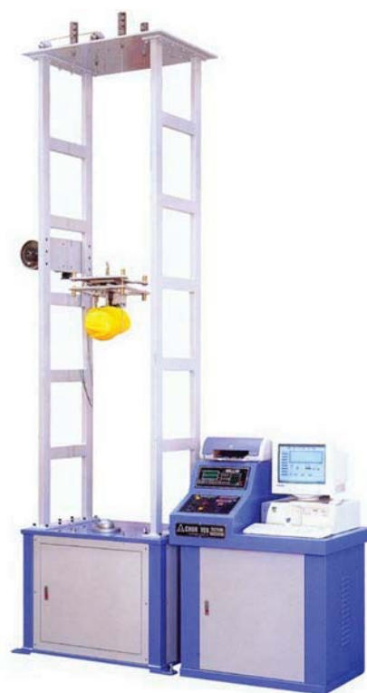
Slika 9.2. Uređaj za ispitivanje apsorpcije energije sudara ( Chun Yen ).
