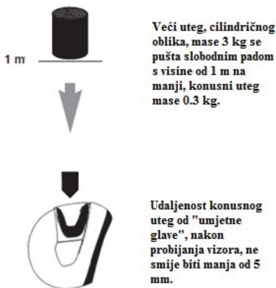
Slika 5.22. Ispitivanje mehaničkih svojstava vizora (penetrirajući test).
