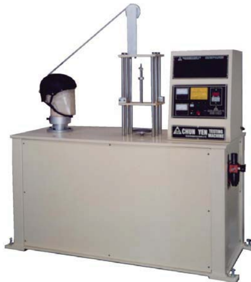
Slika 9.4. Uređaj za ispitivanje odvajanja kacige ( Chun Yen ).
