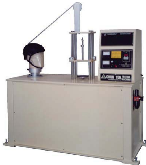
Slika 9.4. Uređaj za ispitivanje odvajanja kacige ( Chun Yen ).
