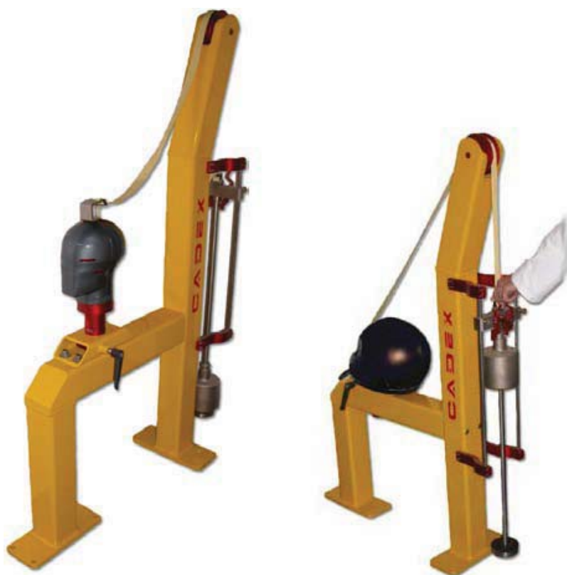
Slika 9.11. Uređaj za ispitivanje odvajanja kacige (Cadex).
