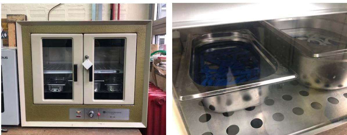
Slika 5.4. Peć za kondicioniranje
