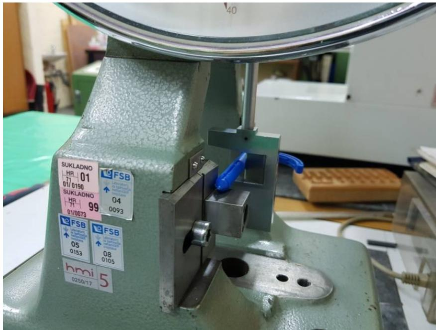
Slika 5.8. Tvorevina pozicionirana za ispitivanje prilikom udara bata
