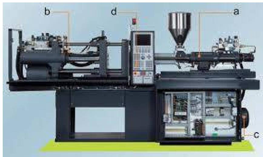
Slika 3.6. Hidraulička ubrizgavalica *Demag* [24]
