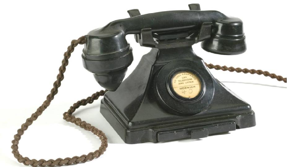
Slika 2.1. Kućište telefona izrađeno od bakelita [3]
