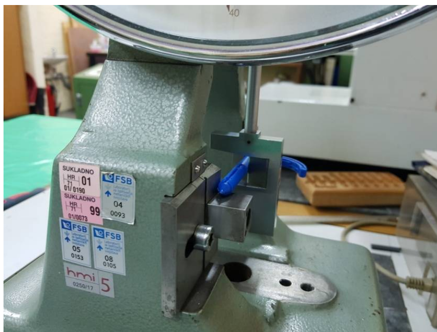
Slika 5.8. Tvorevina pozicionirana za ispitivanje prilikom udara bata
