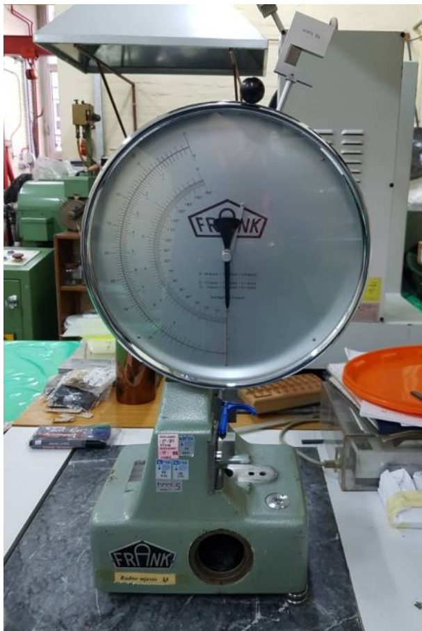
Slika 5.5. Charpyev bat proizvođača Frank
