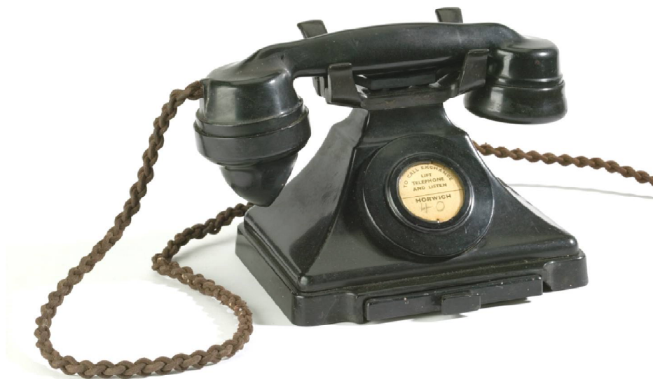
Slika 2.1. Kućište telefona izrađeno od bakelita [3]
