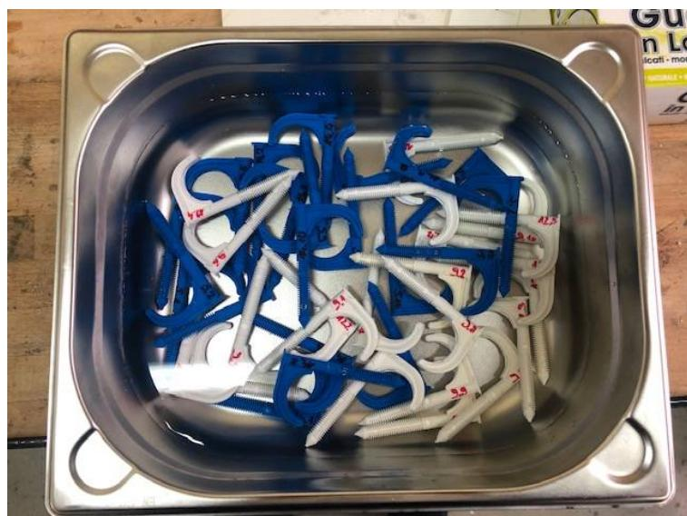
Slika 5.6. Tvorevine nakon označavanja i mjerena mase spremne za kondicioniranje
