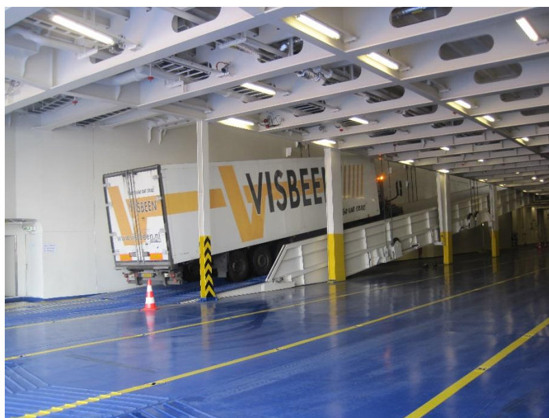
Slika 2. Unutrašnja rampa Ro-Ro broda
