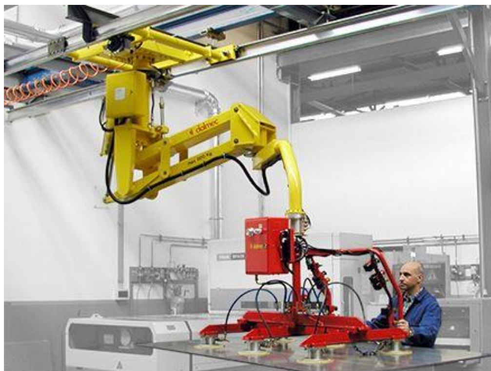
Slika 7. Mobilni stropni manipulator
