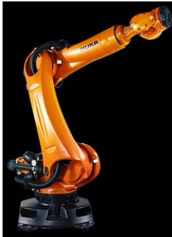
Slika 17. KUKA – KR 180 R3500 ultra K
