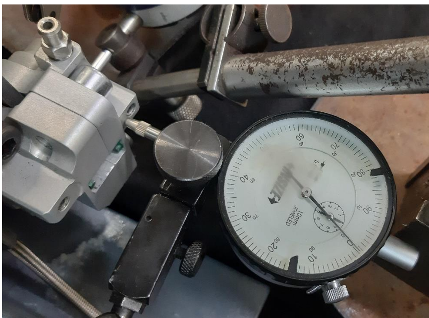
Slika 37. Mjerenje točke T5 na čeljusti stražnjih kočnica
