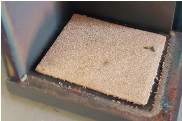
Slika 24. Pločica praha 150/250 sinterirana u vakuumu
