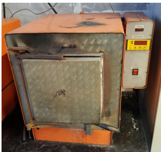
Slika 17. Komorna peć bez zaštitne atmosfere
