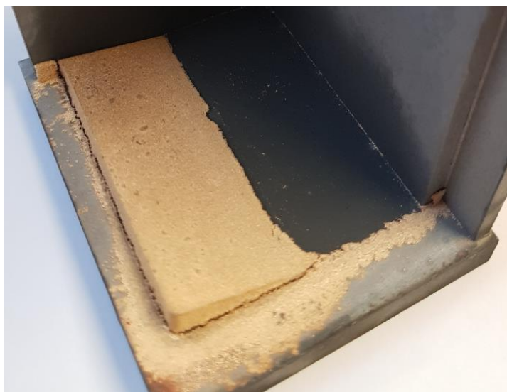
Slika 26. Uzorak praha 53/90 nakon sinteriranja u vakuumu
