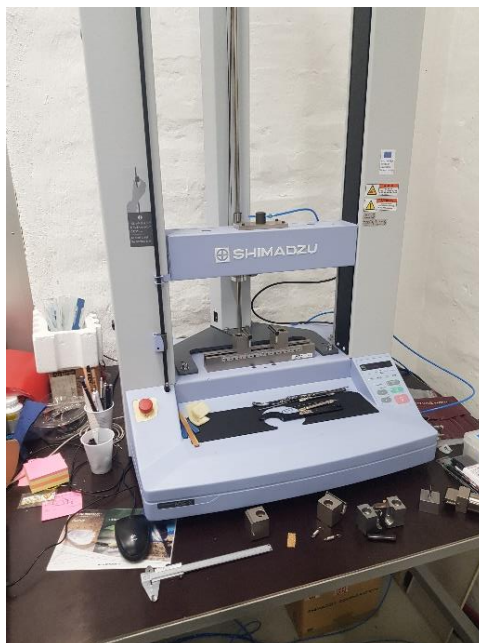
Slika 32. Uređaj za ispitivanje SHIMADZU AG-X
