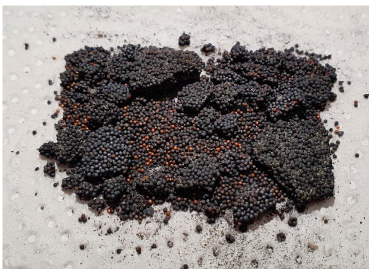
Slika 18. Rezultat sinteriranja bez zaštitne atmosfere
