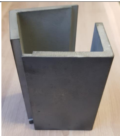
Slika 20. Kalup nakon pjeskarenja
