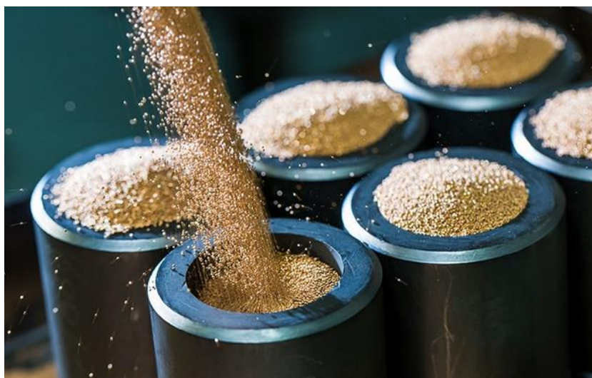
Slika 10. Izrada filtera bez komprimiranja praha [18]
