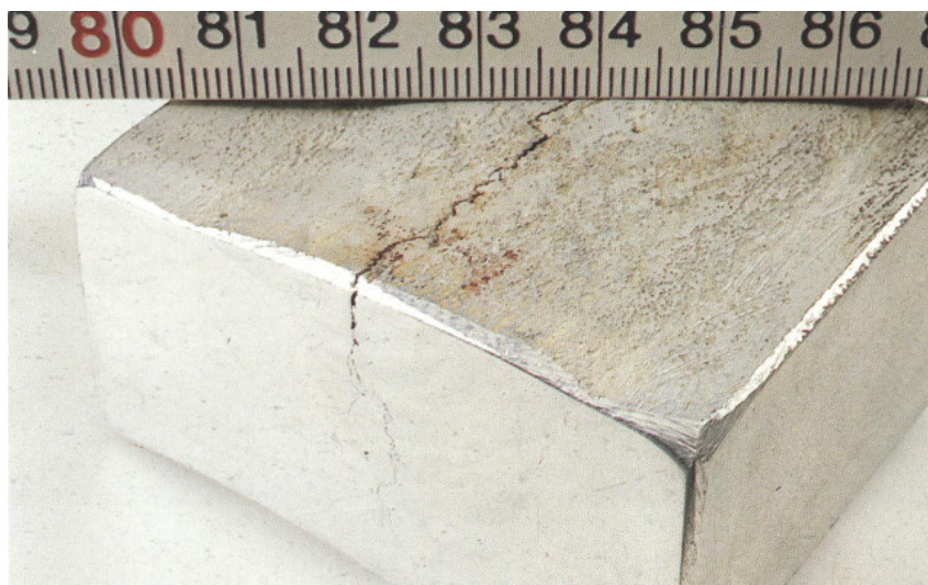
Slika 30: Napetosna korozija aluminija (99%) – transkristalni lom [5]
