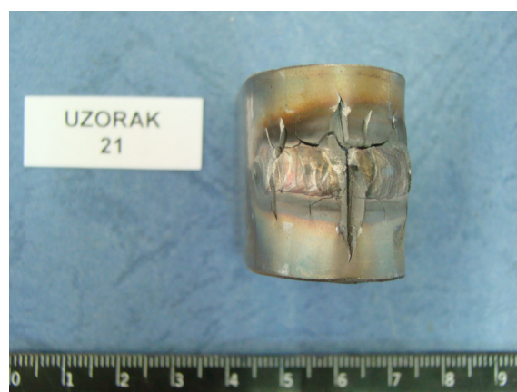
Slika 106: Uzorci 21 – prije ispitivanja - martenzitni nehrđajući čelik kvalitete AISI 420 (uzorak s navarom (desno) – pukotine nastale uslijed zavarivanja)
