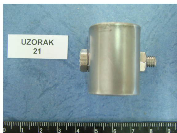
Slika 106: Uzorci 21 – prije ispitivanja - martenzitni nehrđajući čelik kvalitete AISI 420 (uzorak s navarom (desno) – pukotine nastale uslijed zavarivanja)
