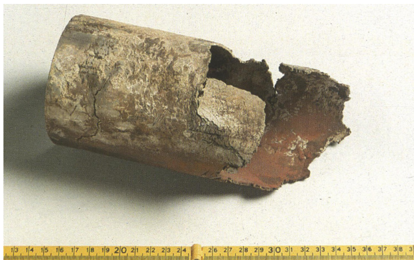
Slika 41: Kloridna napetosna korozija AISI 316 čelika – transkristalan lom [5]
