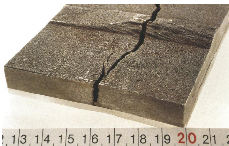
Slika 23: Primjer napetosne korozije ugljičnog čelika u zoni zavarenog spoja – interkristalan lom [5]
