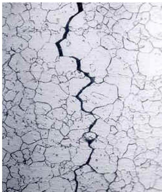
Slika 38: Napetosna korozija AISI 304 čelika – interkristalan lom [18]
