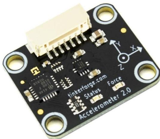
Slika 16. Tinkerforge akcelerometar [19]
