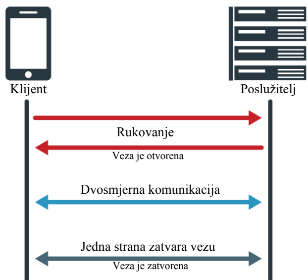
Slika 13. Princip rada WebSocket protokola [16]
