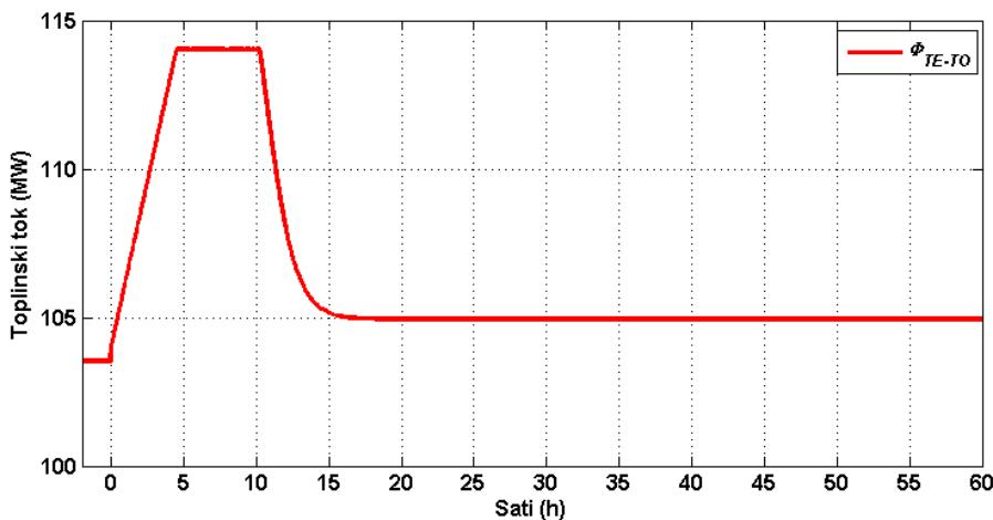
Slika 38. Predan toplinski tok s izvora toplinske energije (prag TE-TO) u sustav Realnog modela pri konstantom dodatnom toplinskem toku od 10 MW, pri temperaturi okoliša od  $-10^{\circ}\text{C}$
