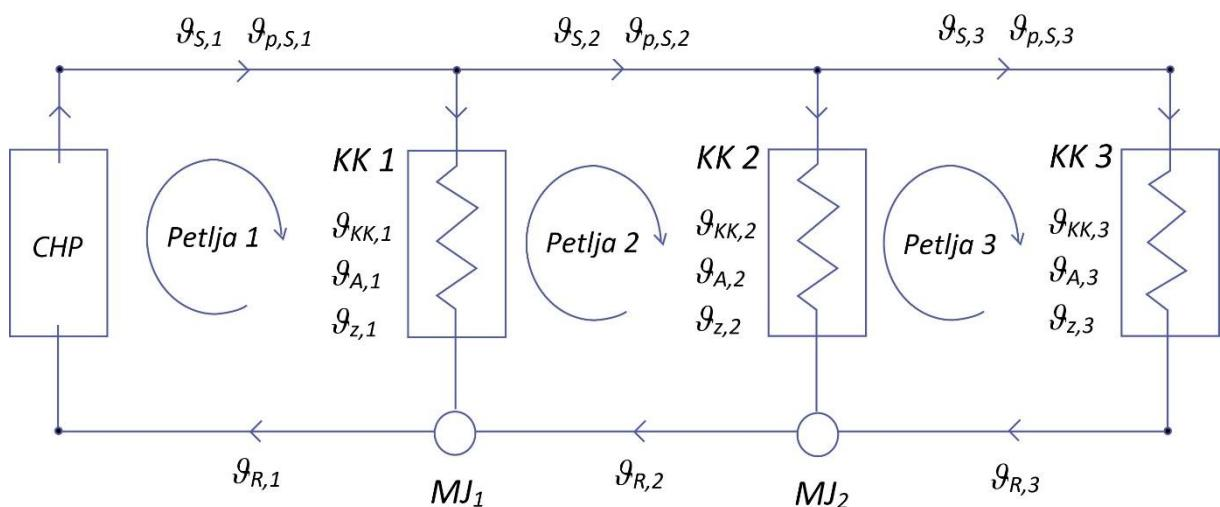
Slika 5. Shema termodinamičkog modela sustava daljinskog grijanja Osnovnog modela
