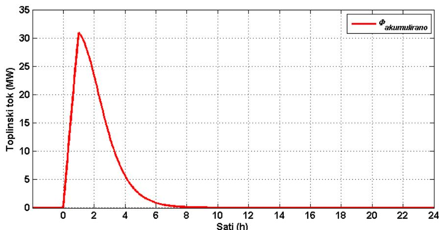
Slika 27. Toplinski tok za akumulaciju (pohranu) toplinske energije unutar sustava Realnog modela pri skokovitoj promjeni temperature polaza za  $+15^{\circ}\text{C}$  pri temperaturi okoliša od  $0^{\circ}\text{C}$
