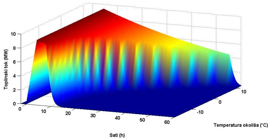
*Slika 41. Prikaz toplinskog toka za akumulaciju (pohranu) toplinske energije u ovisnosti o temperaturi okoliša i nametnutom poremećaju u obliku konstantnog dodatnog toplinskog toka od 10 MW<sub>t</sub>*
