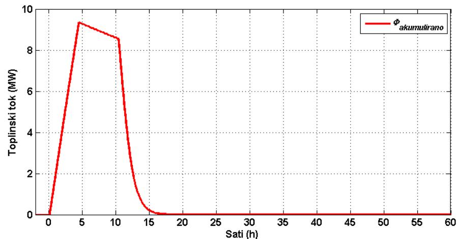
Slika 39. Toplinski tok za akumulaciju (pohranu) toplinske energije unutar sustava Realnog modela pri konstantom dodatnom toplinskem toku od 10 MW, pri temperaturi okoliša od  $-10^{\circ}\text{C}$
