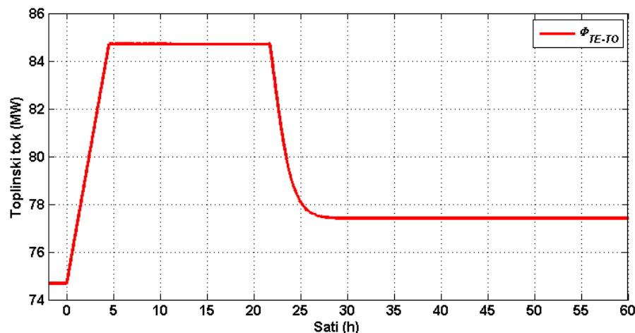
Slika 35. Predan toplinski tok s izvora toplinske energije (prag TE-TO) u sustav Realnog modela pri konstantom dodatnom toplinskem toku od  $10 \text{ MW}_t$  pri temperaturi okoliša od  $0^\circ\text{C}$
