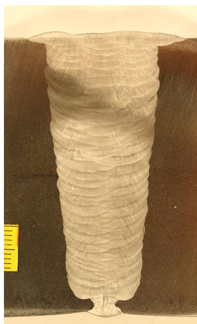
Slika 33. Izgled pripremljenog makroizbruska za mjerenje udjela ferita i ispitivanje mikrostrukture
