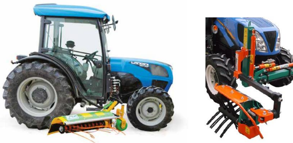
Slika 6. Izvedbe koje se pričvršćuju na okvir traktora
