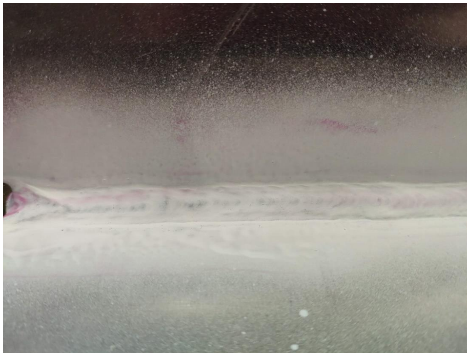
Slika 51. Penetrantska metoda provedena na zavaru nastalom konvencionalnim zavarivanjem pulsniim strujama
