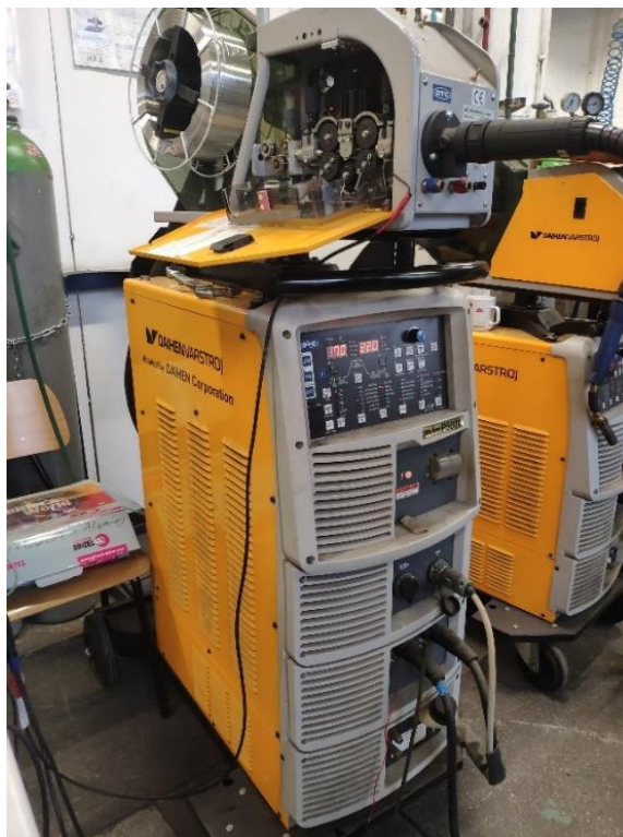
Slika 27. Welbee P500L, Daihen Varstroj
