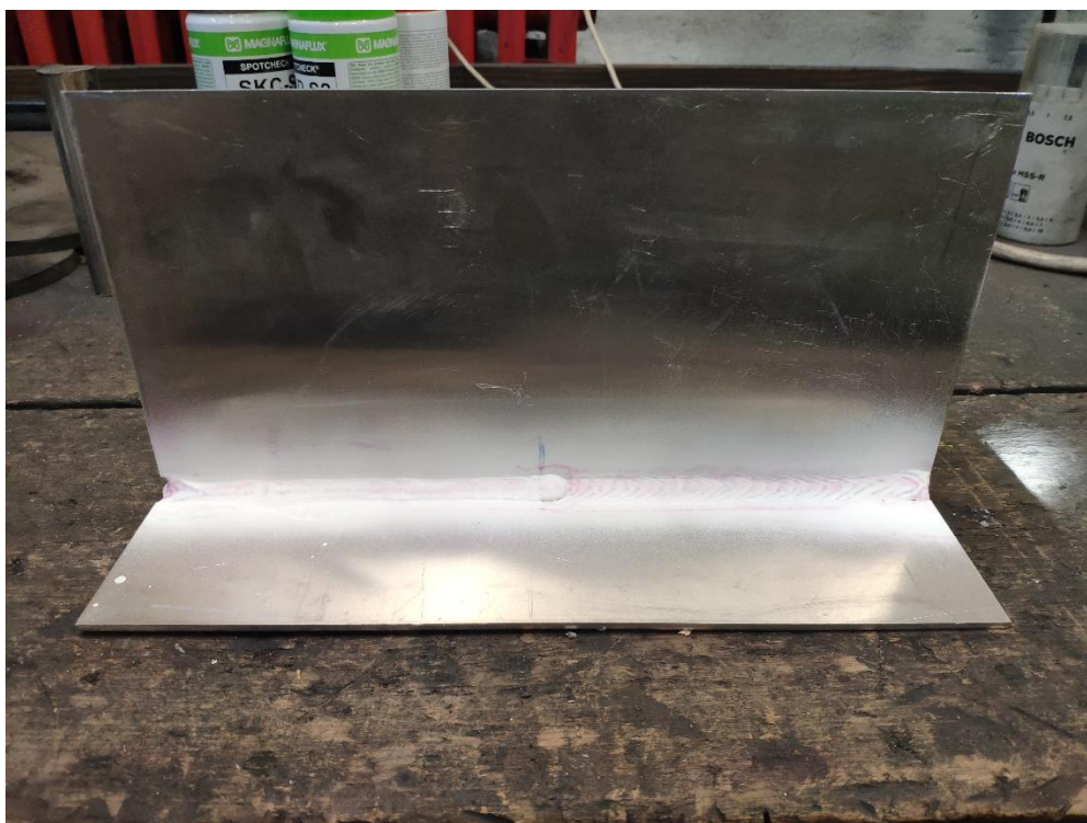
Slika 49. Zavar nakon nanošenja penetranta i razvijajača
