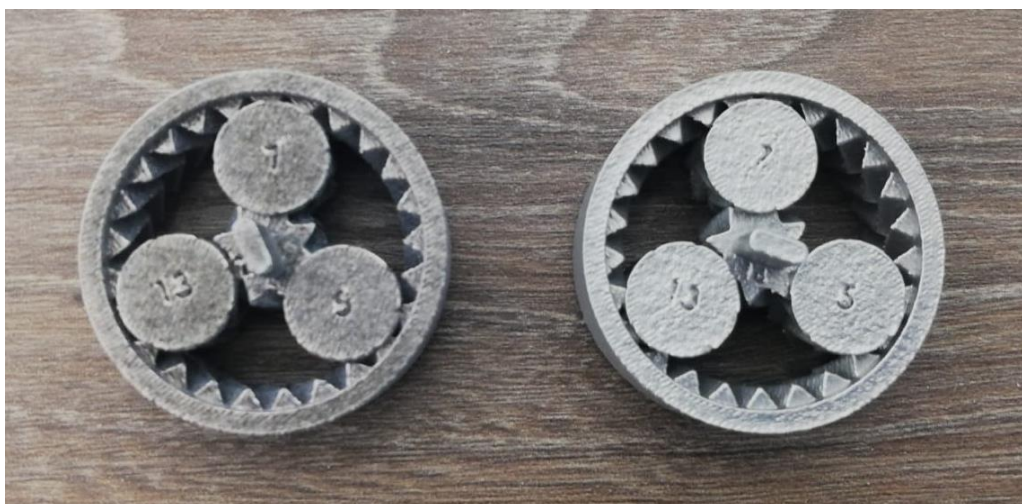
Slika 27. Primjer nestaklarenog i staklarenog modela
