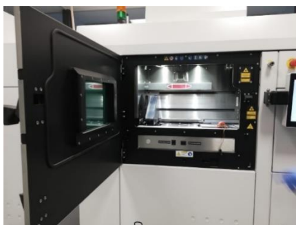
Otvorena komora printera EOS M 290
