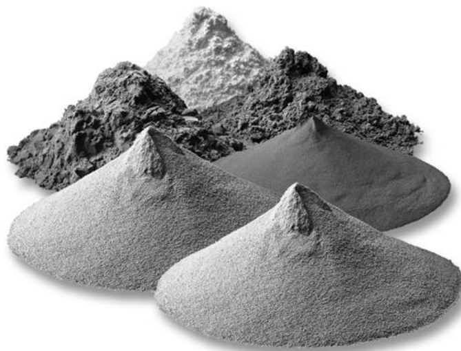
Slika 8. Metal u praškastom obliku [8]
