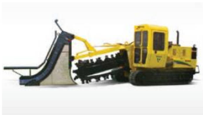
Slika 5.1. Rovokopač s nastavkom za automatsko postavljanje cijevi u rov [26]
