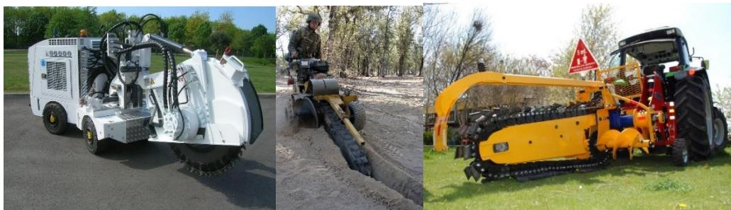
Slika 2.3. Primjeri mikro, prijenosnog i traktorskog rovokpača [6]
