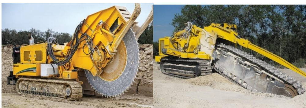
Slika 2.2. Primjeri rovokopača sa iskapačkim rotorom odnosno iskapačkim lancem [6]
