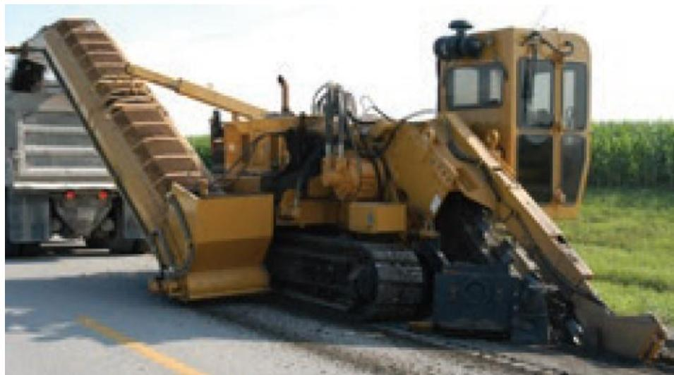
Slika 5.7. Primjer rovokopača s nadograđenom transportnom trakom [26]
