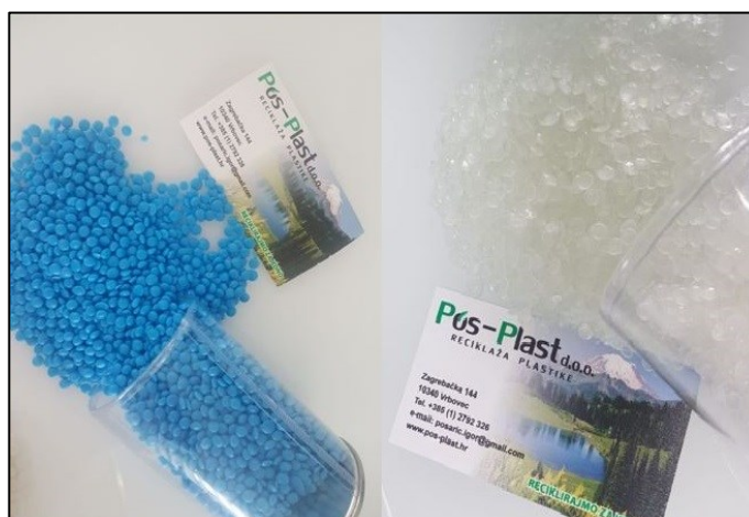
Slika 15. Produkti dobiveni nakon mehaničke obrade u Pos-Plastu-u [26]
