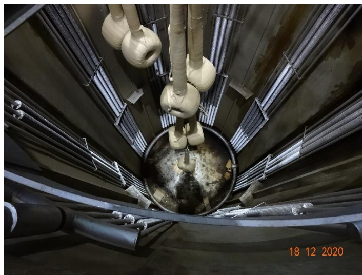
Slika 4.1. Pogled u praznu vakuumsku komoru
