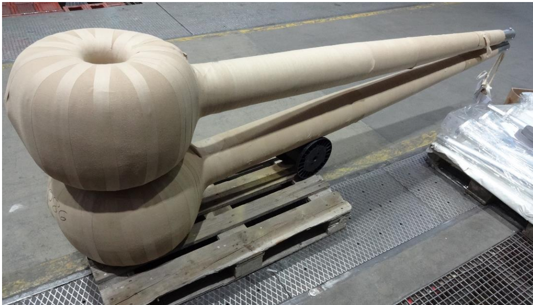
Slika 1.4. Primjer mjernih transformatora spremnih za vakuumsko sušenje
