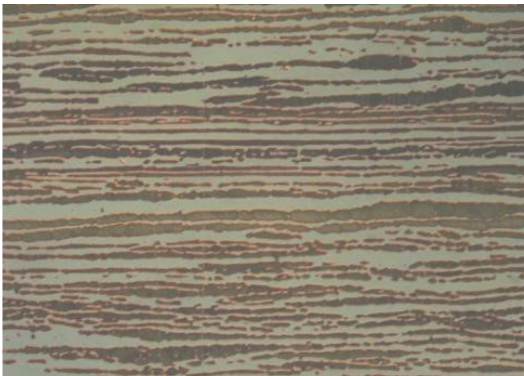
Slika 7. Mikrostruktura dupleks čelika [3]
