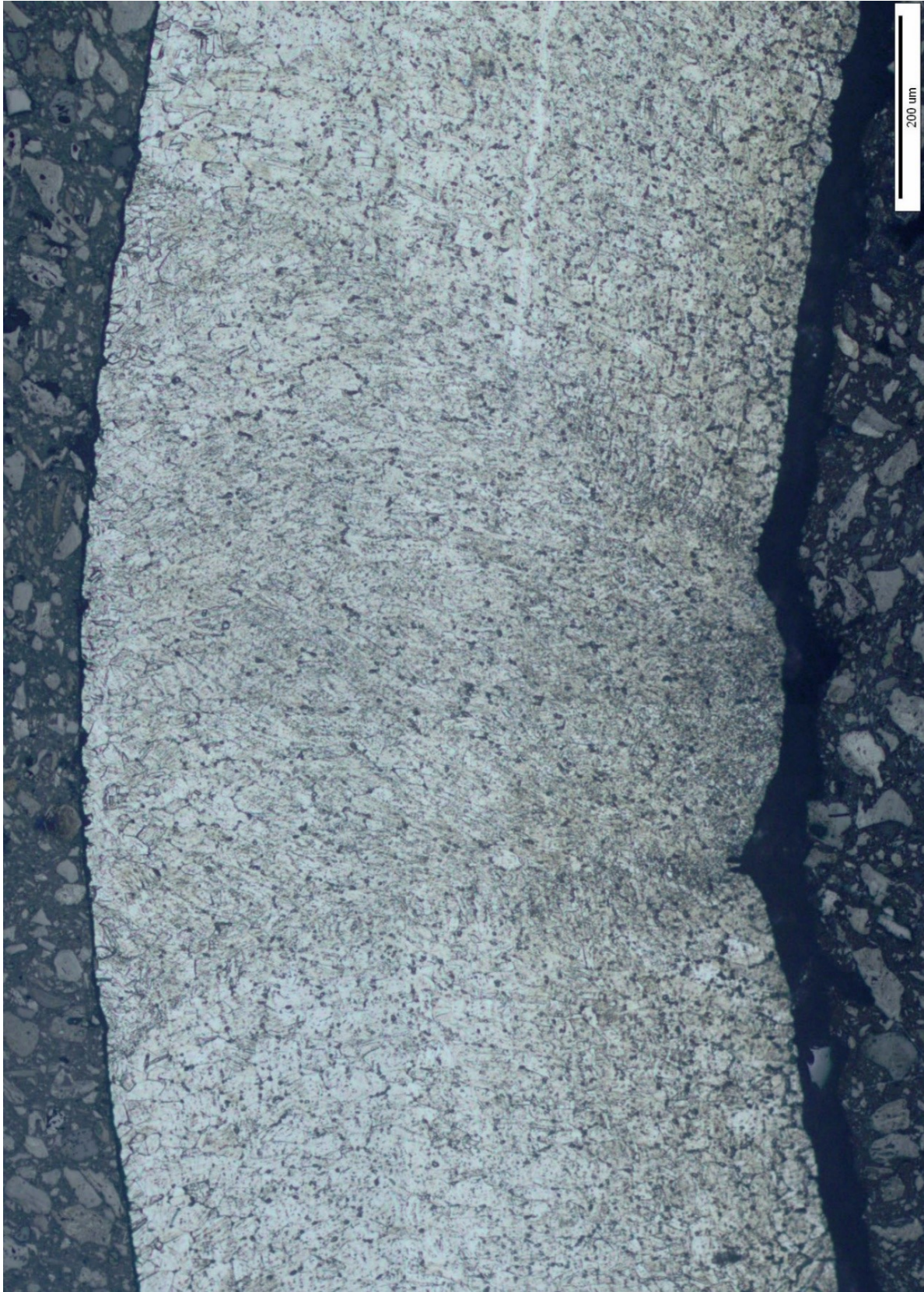
Slika 60. Mikrostruktura zavarenog spoja nakon rastvornog žarenja; v=1,00 m/min pri većem povećanju
