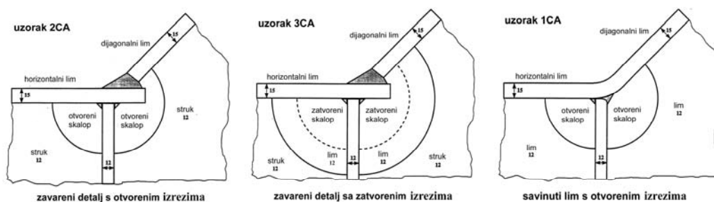
Slika 2.50 Konfiguracije detalja zgloba [25]
