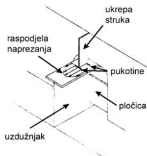
Slika 2.49 Mjesto nastanka zamorne pukotine na spoju uzdužnjaka i okvirnog rebra
