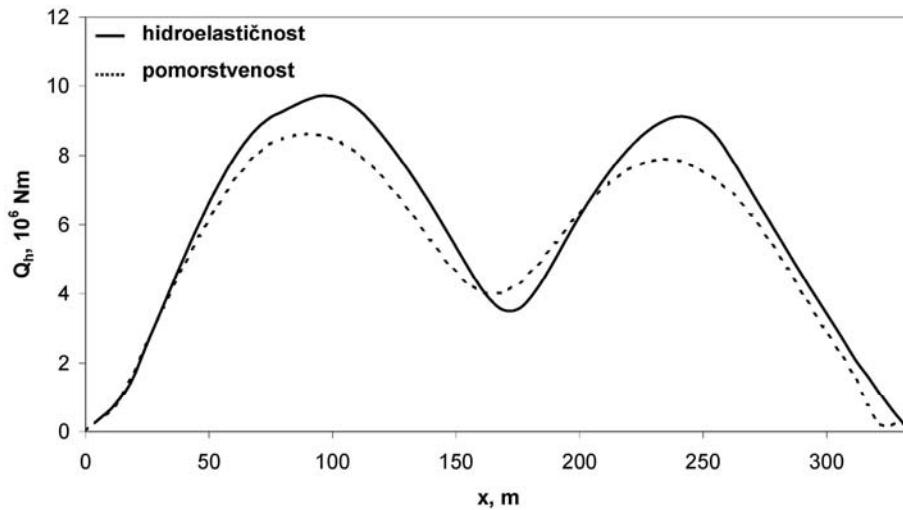
Slika 6.58 Horizontalna sмиčna sila za potpuno nakrcan brod,  $\omega = 0.7 \text{ rad/s}$ ,  $\beta = 120^\circ$ ,
