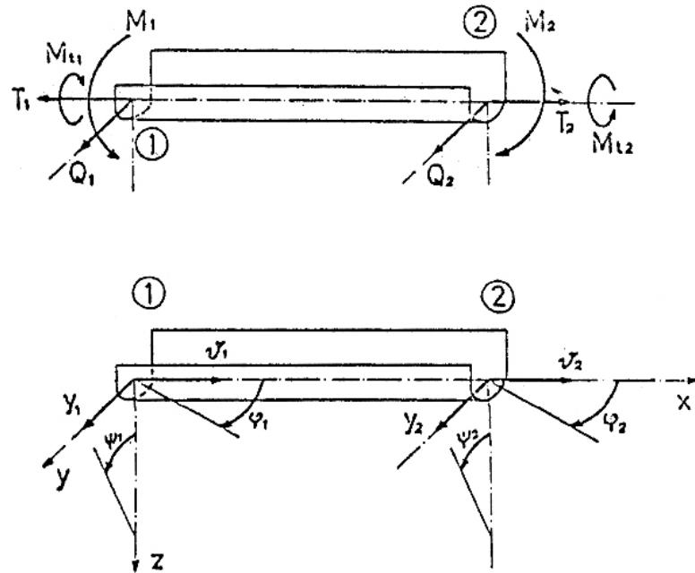
Slika 2.7 Gredni konačni element s osam stupnjeva slobode [49]
