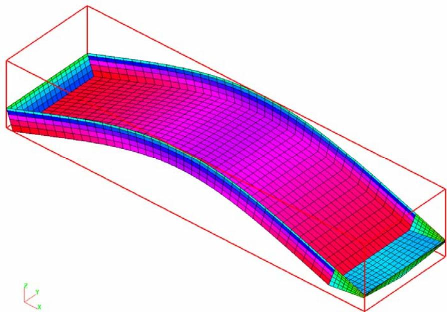
Slika 6.21 Prvi suhi prirodni oblik vertikalnih vibracija barže,  $\omega_1 = 5.21$  rad/s
