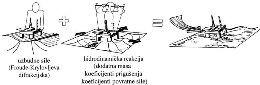
Slika 3.8 Komponente hidrodinamičkih sila na tijelo [53]
