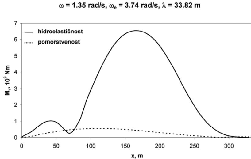
Slika 6.48 Vertikalni moment savijanja za potpuno nakrcan brod,  $\omega = 1.35 \text{ rad/s}, \beta = 180^\circ$ ,
