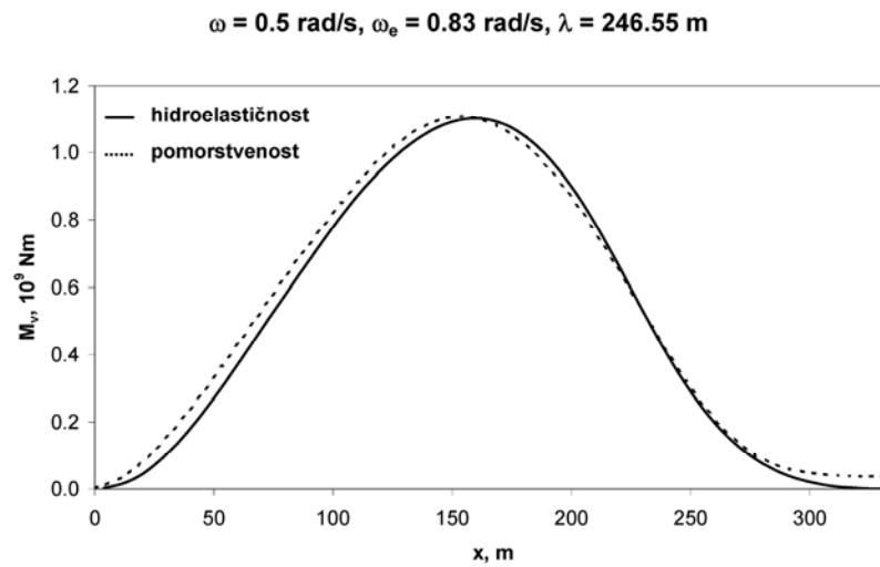
Slika 6.46 Vertikalni moment savijanja za potpuno nakrcan brod,  $\omega = 0.5 \text{ rad/s}$ ,  $\beta = 180^\circ$ ,
