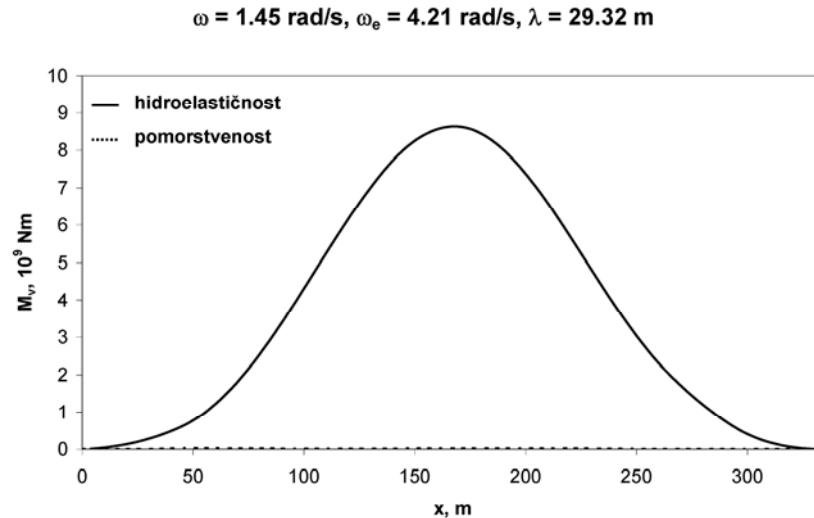
Slika 6.52 Vertikalni moment savijanja za brod u balastu,  $\omega = 1.45$  rad/s,  $\beta = 180^\circ$ ,
