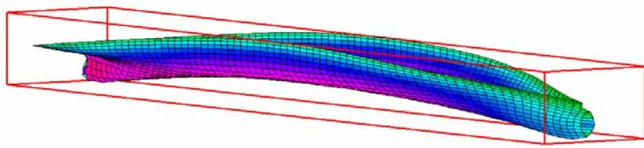
Slika 6.40 Prvi suhi prirodni oblik vertikalnih vibracija,  $\omega_1 = 4.01$  rad/s
