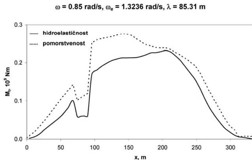
Slika 6.60 Moment uvijanja za potpuno nakrcan brod,  $\omega = 0.85 \text{ rad/s}$ ,  $\beta = 120^\circ$ ,
