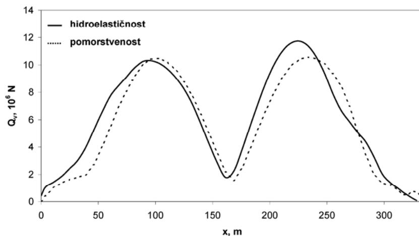
Slika 6.51 Vertikalna smična sila za brod u balastu,  $\omega = 0.45$  rad/s,  $\beta = 180^\circ$ ,
