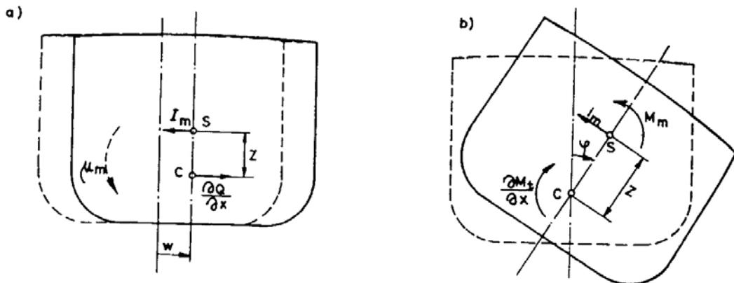
Slika 2.2 Sprega horizontalnih i torzijskih vibracija [43]
