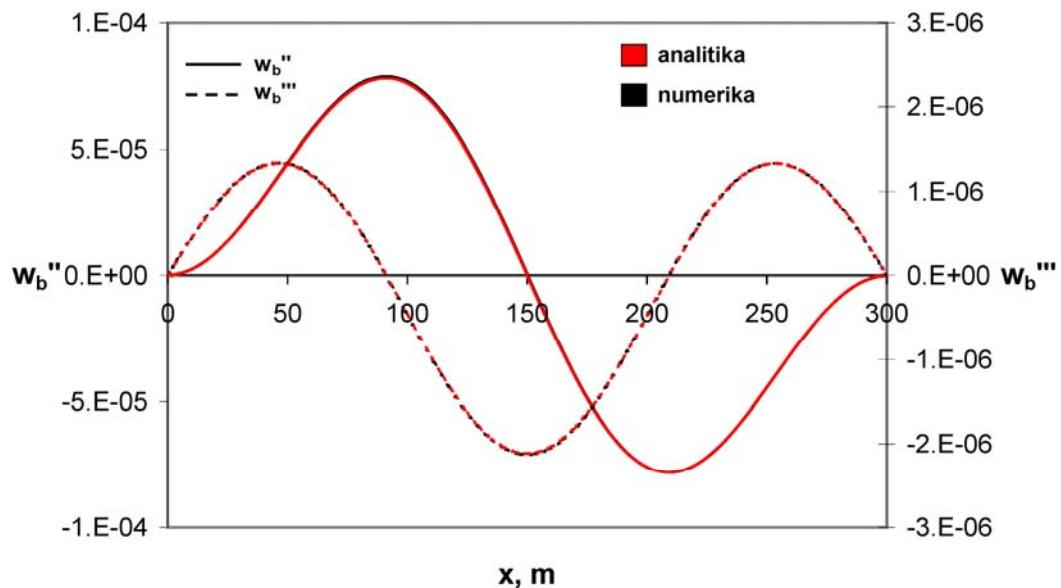
Slika 6.11 Presječne sile savijanja za treći prirodni oblik
