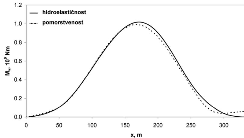
Slika 6.50 Vertikalni moment savijanja za brod u balastu,  $\omega = 0.45$  rad/s,  $\beta = 180^\circ$ ,
