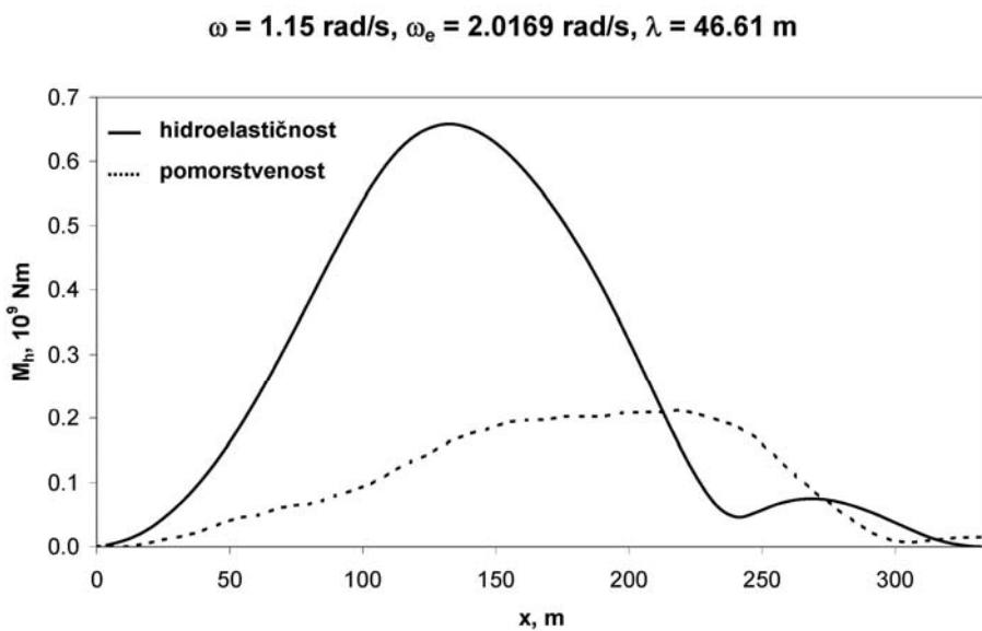
Slika 6.57 Horizontalni moment savijanja za potpuno nakrcan brod,  $\omega = 1.15 \text{ rad/s}$ ,  $\beta = 120^\circ$ ,
