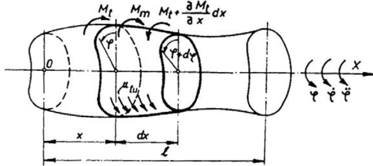
Slika 2.5 Gredni model zatvorenog poprečnog presjeka [43]
