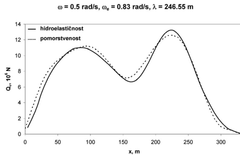
Slika 6.47 Vertikalna smična sila za potpuno nakrcan brod,  $\omega = 0.5 \text{ rad/s}$ ,  $\beta = 180^\circ$ ,
