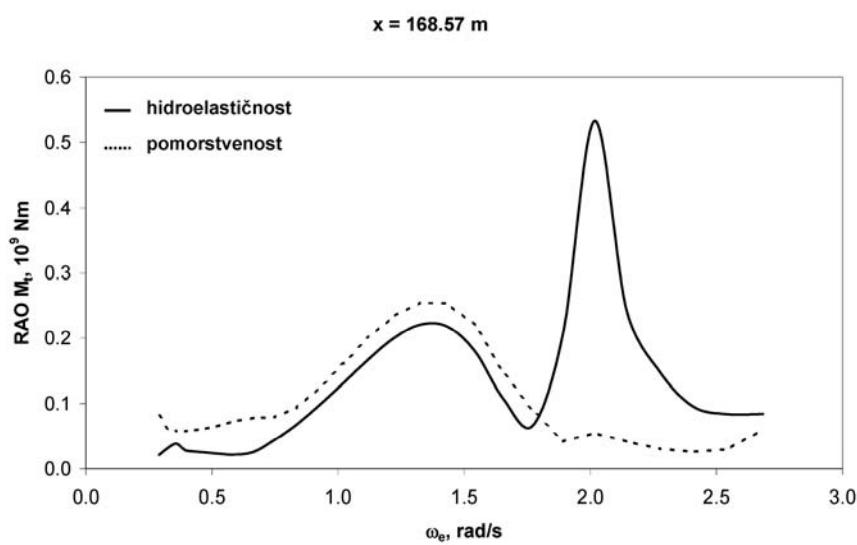
Slika 6.55 Prenosne funkcije momenta uvijanja po sredini potpuno nakrcanog broda,  $x = 168.57 \text{ m}$ ,  $\beta = 120^\circ$ ,  $U = 25 \text{ čv}$ ,  $h = 2 \text{ m}$
