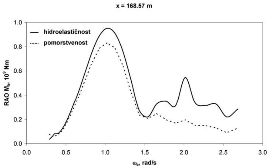
Slika 6.54 Prenosne funkcije horizontalnog momenta savijanja po sredini potpuno nakrcanog broda,  $x = 168.57 \text{ m}$ ,  $\beta = 120^\circ$ ,  $U = 25 \text{ čv}$ ,  $h = 2 \text{ m}$
