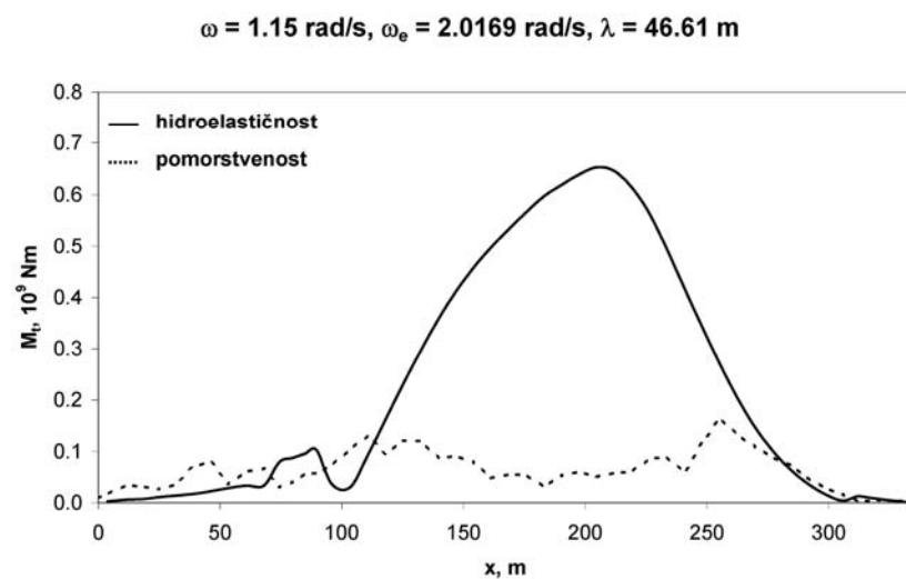
Slika 6.61 Moment uvijanja za potpuno nakrcan brod,  $\omega = 1.15 \text{ rad/s}$ ,  $\beta = 120^\circ$ ,
