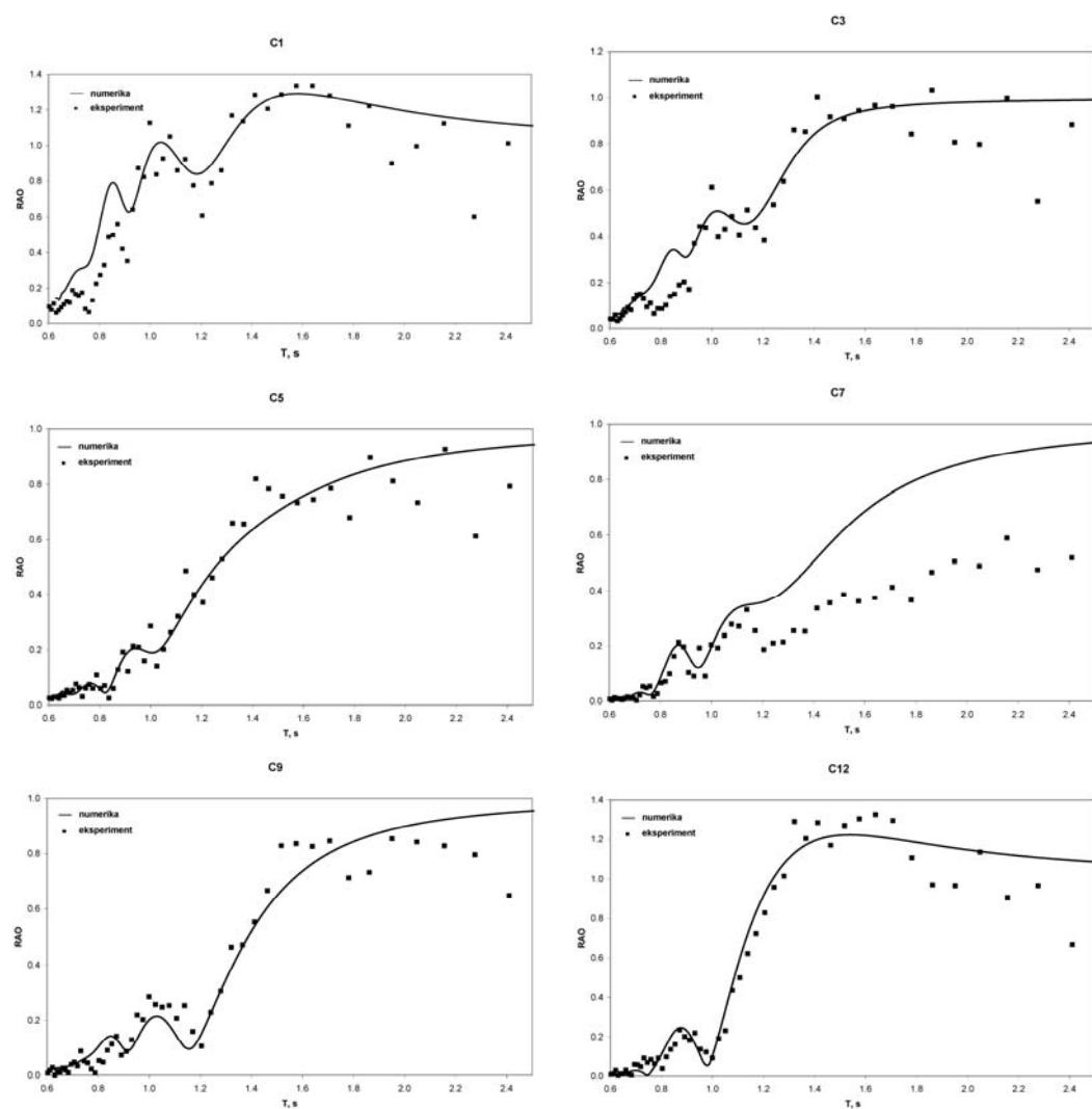
Slika 6.25 Prenosne funkcije poniranja u šest referentnih točaka
