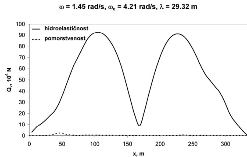
Slika 6.53 Vertikalna smična sila za brod u balastu,  $\omega = 1.45$  rad/s,  $\beta = 180^\circ$ ,
