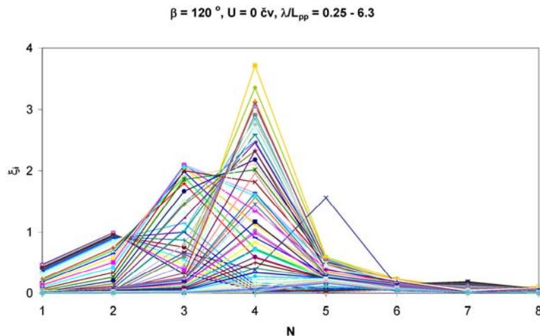
Slika 6.19 Apsolutne vrijednosti amplituda normiranih modova vertikalnog odziva
