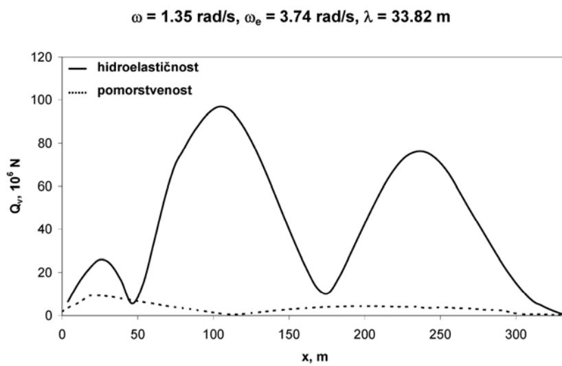
Slika 6.49 Vertikalna smična sila za potpuno nakrcan brod,  $\omega = 1.35 \text{ rad/s}, \beta = 180^\circ$ ,
