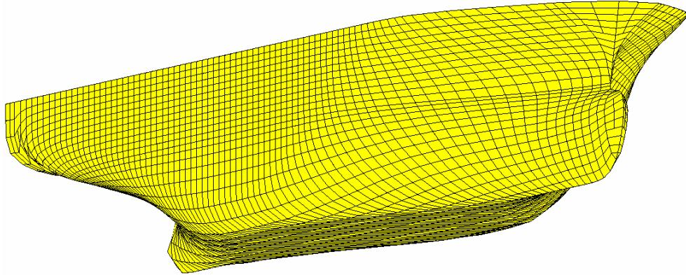
Slika 3.13 Hidrodinamički model oplakane površine broda
