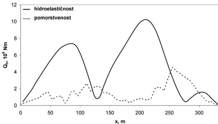
Slika 6.59 Horizontalna sмиčna sila za potpuno nakrcan brod,  $\omega = 1.15 \text{ rad/s}$ ,  $\beta = 120^\circ$ ,
