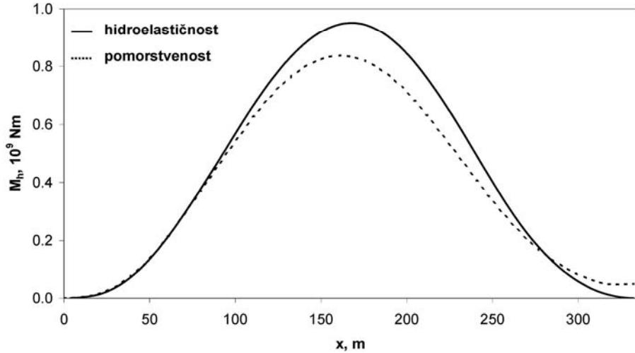
Slika 6.56 Horizontalni moment savijanja za potpuno nakrcan brod,  $\omega = 0.7 \text{ rad/s}$ ,  $\beta = 120^\circ$ ,
