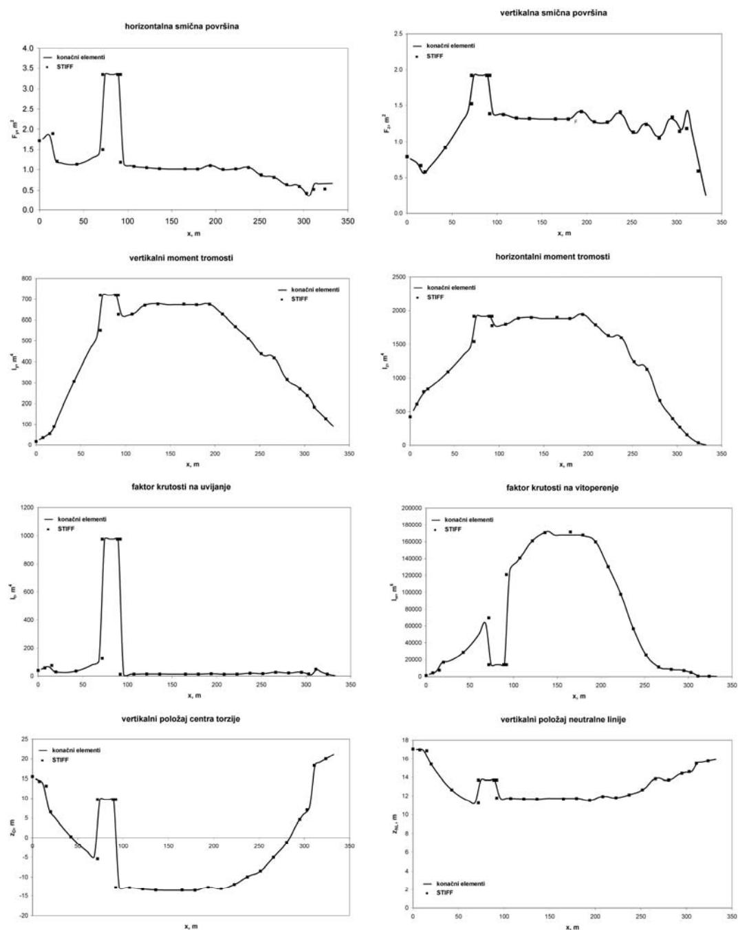
Slika 6.37 Geometrijske značajke poprečnih presjeka duž kontejnerskog broda
