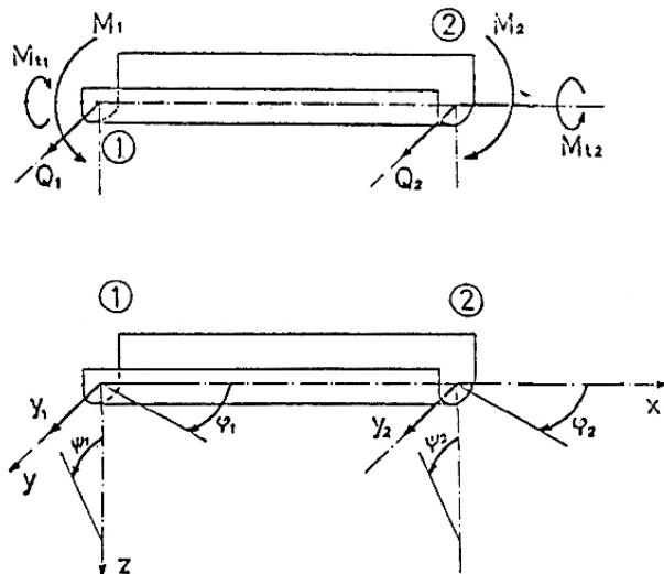
Slika 2.9 Gredni konačni element sa šest stupnjeva slobode [49]
