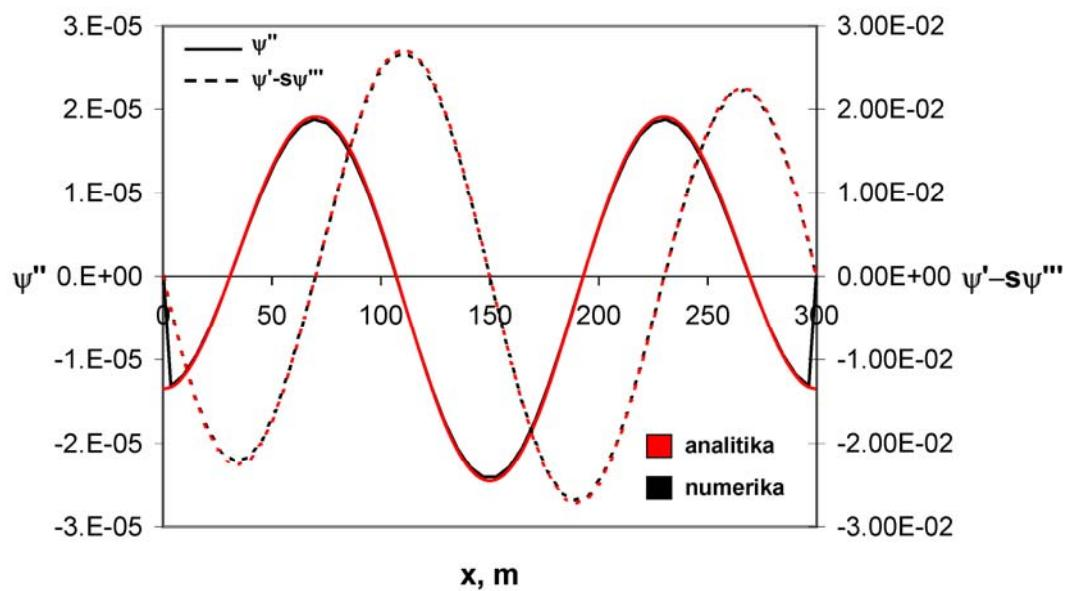
Slika 6.14 Presječne sile uvijanja za četvrti prirodni oblik
