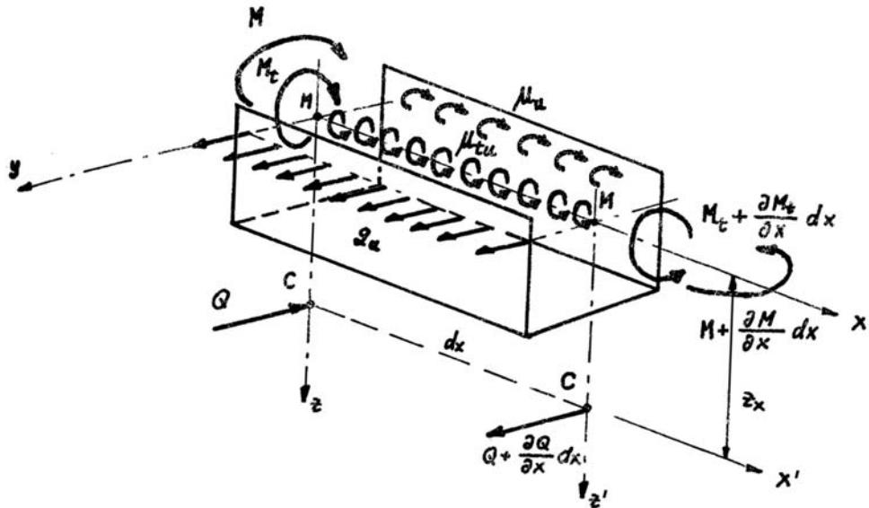
Slika 2.6 Gredni model trupa otvorenog presjeka [44]
