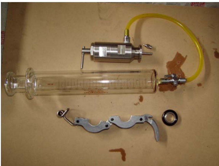
Slika 3 - 2: Pribor za uzimanje uzoraka transformatorskog ulja
