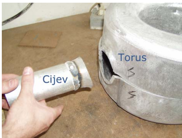
Slika 6 - 6: Uzorak 1 – odvojen od torusa
