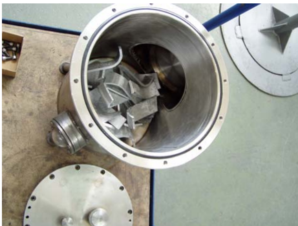
Slika 6 - 10: Posuda sa uzorkom 2 (materijal torusa) prije zatvaranja
