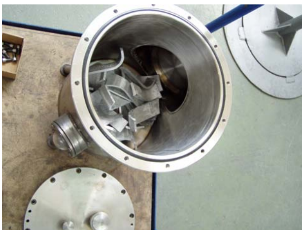
Slika 6 - 10: Posuda sa uzorkom 2 (materijal torusa) prije zatvaranja
