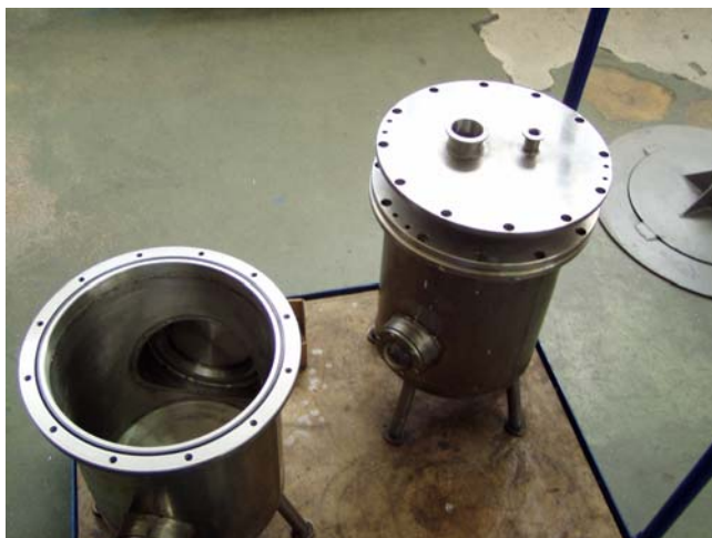
Slika 6 - 4: Vakuumstalne posude za provedbu pokusa
