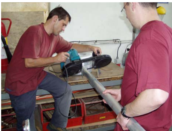
Slika 6 - 5: Izdvajanje područja zavarenog spoja cijev-torus
