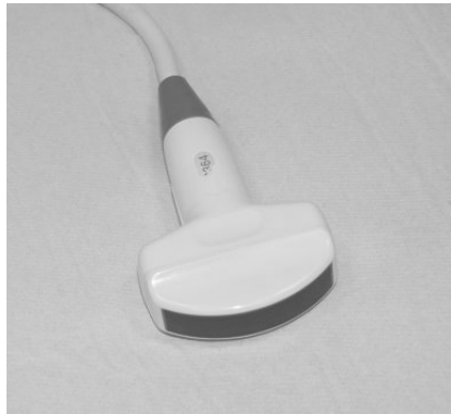
Slika 80. Prikaz korištene mjerne sonde C364.
