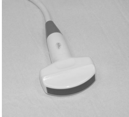
Slika 80. Prikaz korištene mjerne sonde C364.
