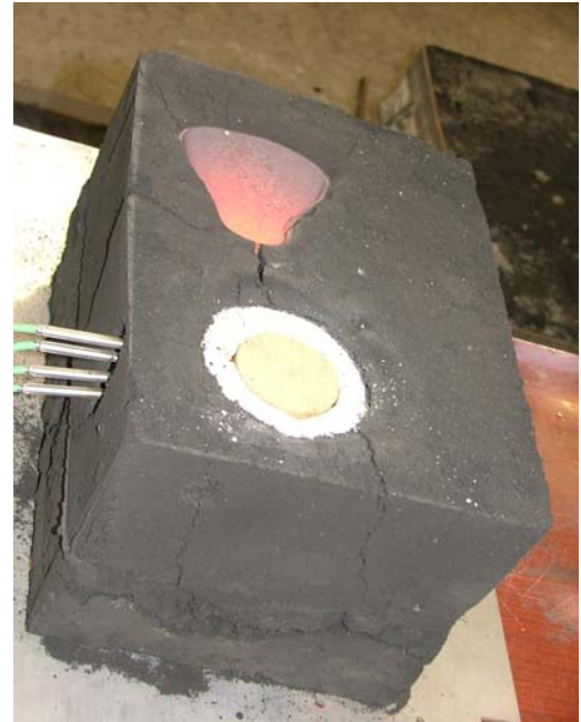
Slika 7.9. Sivi lijev prilikom mjerenja
