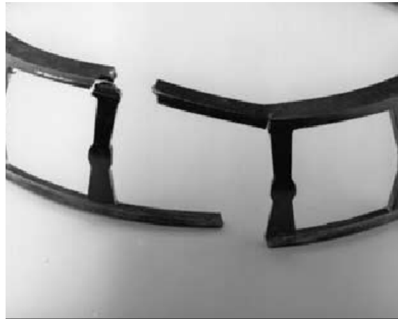
Slika 4.9 Razoran prijelom kaveza kotrljajnog ležaja [110]
