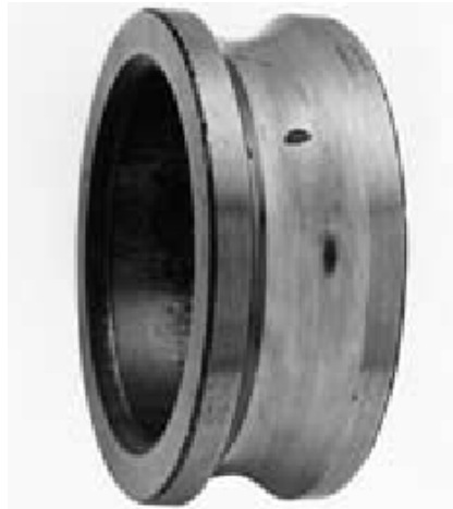
Slika 4.7 Točkasto oštećenje nastalo zamorom na unutrašnjoj kotrljajnoj stazi kugličnog ležaja [110]
