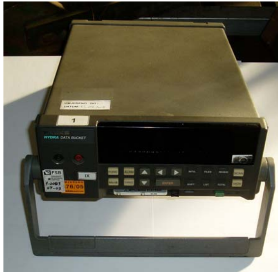
Slika 5.5 Uređaj za pohranjivanje podataka vrijednosti temperature „Fluke – Hydra” s ispitivanog ležaja SKF 6206
