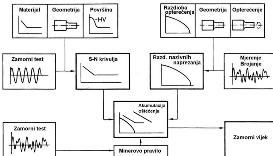
Slika 2-4 Shema S-N pristupa određivanju zamornog oštećenja
