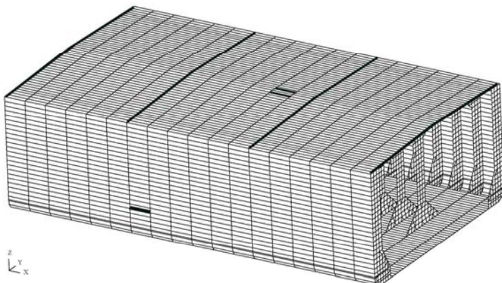
**Slika 8-15 Položaj struktturnih detalja na globalnom modelu**
