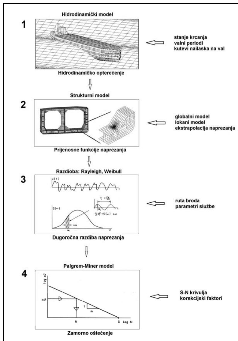
Slika 2-6 Shematski prikaz četiri koraka spektralne analize
