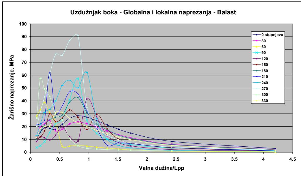
Slika 8-12 Prijenosne funkcije žarišnih naprezanja – uzdužnjak boka, balast
