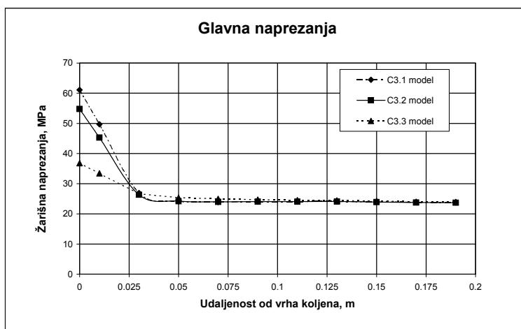
**Slika 4-12 Razdioba naprezanja pred vrhom koljena okvirnog rebra**
