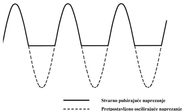
**Slika 3-2 Prepostavljena i stvarna promjena lokalnog naprezanja**
