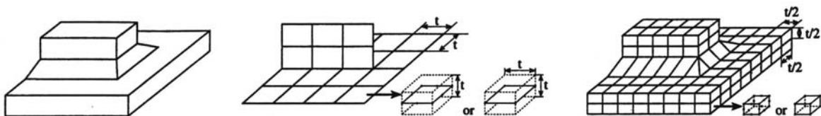
Slika 4-13 Modeliranje strukturalnih detalja 2D i 3D konačnim elementima
