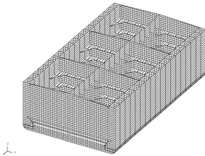
**Slika 8-2 Globalni struktturni model**
