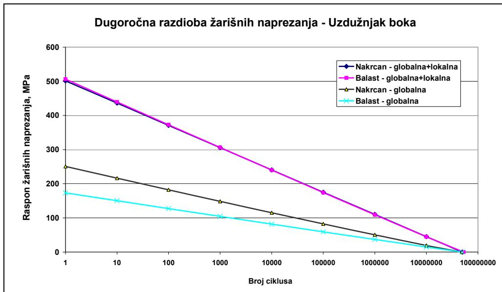
Slika 8-14 Dugoročna razdioba žarišnih naprezanja
