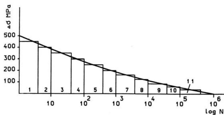
**Slika 6-4 S-N krivulja za opterećenja promjenjive amplitude**
