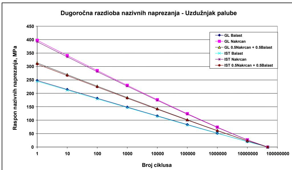
Slika 8-18 Dugoročna razdioba naprezanja za uzdužnjak palube
