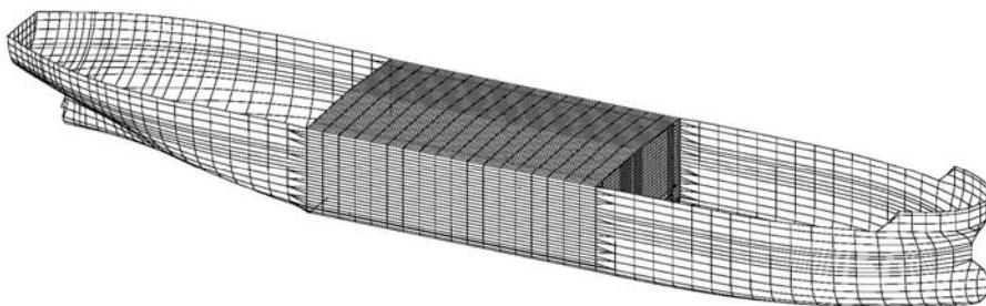
**Slika 8-1 Hidrodinamički model broda**
