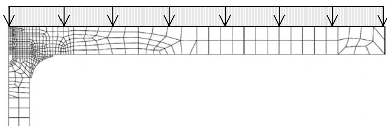
**Slika 8-6 Jedinično kontinuirano opterećenje lokalnog grednog modela**
