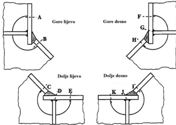
Slika 4-7 Shematski prikaz položaja pukotina na C2.2 uzorku [38]
