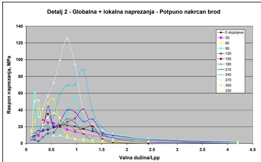
**Slika 8-22 Prijenosne funkcije rezultirajućih žarišnih naprezanja za detalj 2**
