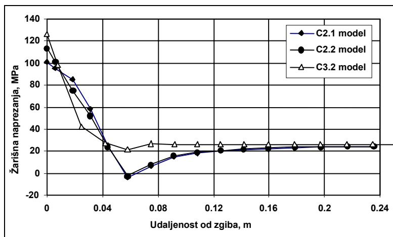
Slika 4-6 Razdioba naprezanja za C2 model zgiba
