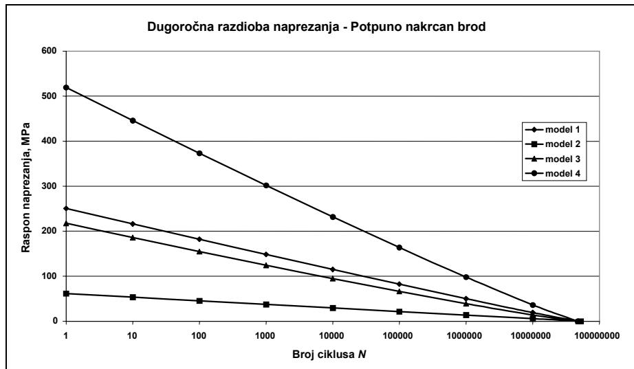
Slika 8-23 Dugoročna naprezanja za detalje 1, 2, 3 i 4
