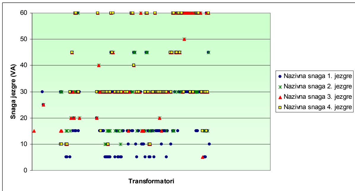
Slika 4-8. Prikaz cjelokupne ostvarene vanjske raznolikosti strujnih mjernih transformatora u ovisnosti o snazi jezgri
