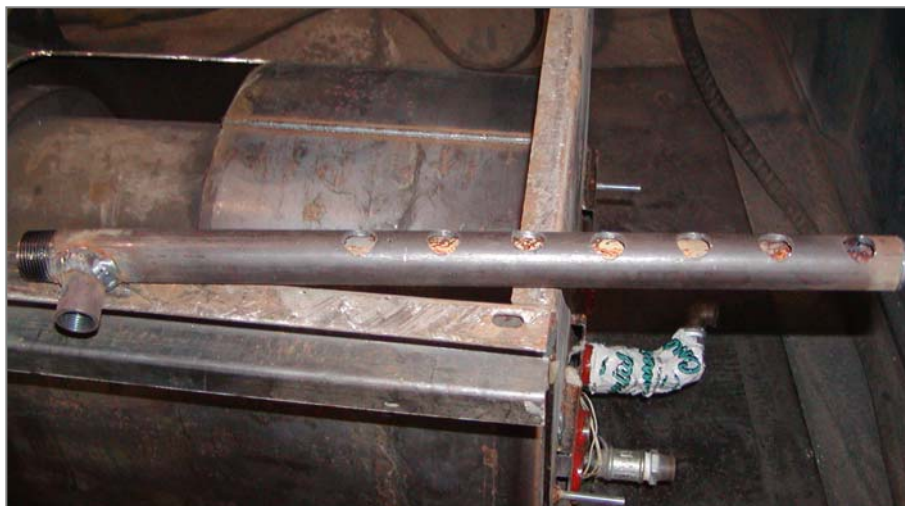
Slika 6.25 Povratni vod kod četvrtog prototipa NTK25
