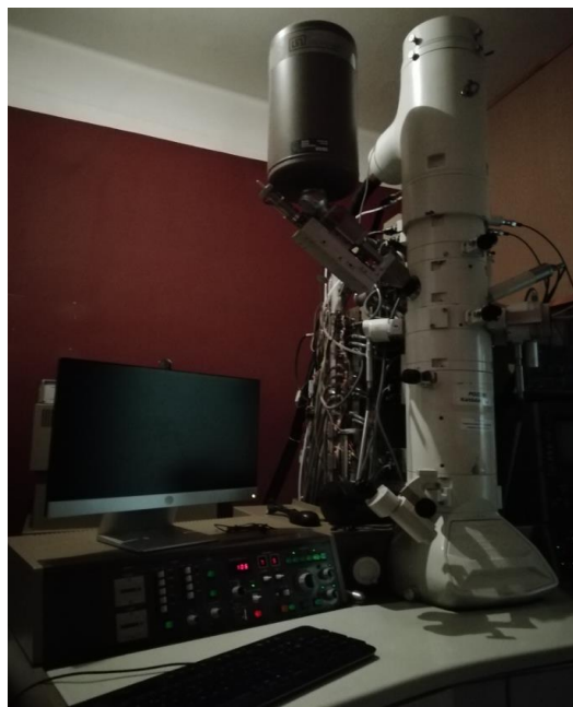
Slika 6-14. Transmisijski elektronski mikroskop JEOL JEM-2000-FX.
