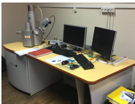
Slika 6-11. Pretražni elektronski mikroskop Tescan VEGA 5136 MM.
