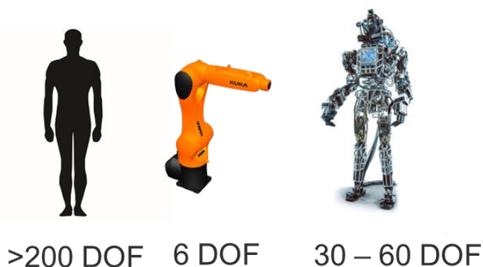
Slika 2-1. Razlike u fizičkim karakteristikama robota s obzirom na broj stupnjeva slobode.
