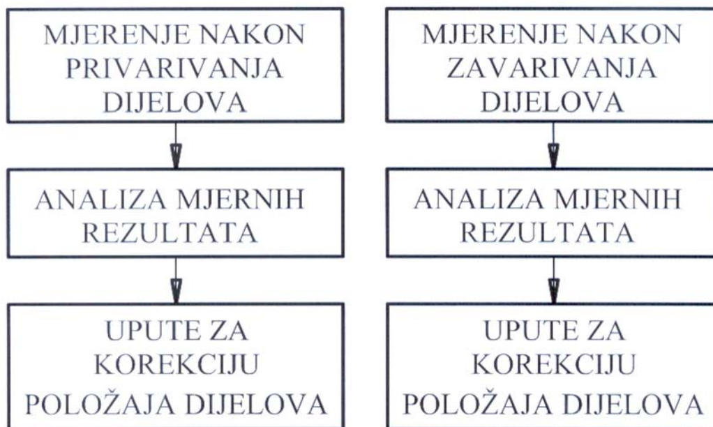
Slika 59: Pregled kontrole dimenzija i oblika u tokovima privarivanja i zavarivanja sekcije
