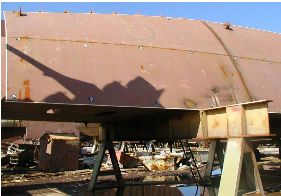
Slika 76: Sekcija na okvirnim potkladama
