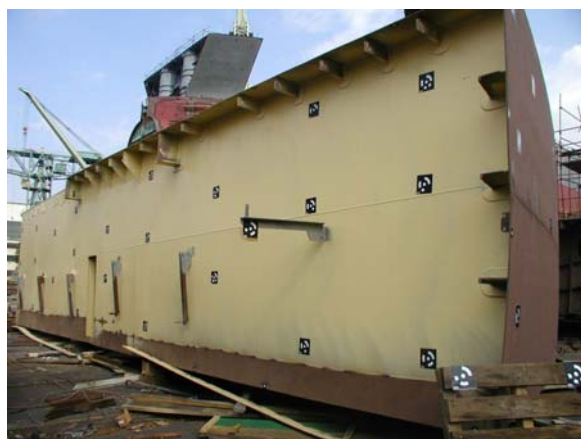
Slika 98: Mjerne točke na poprečnoj pregradi na rebru 10
