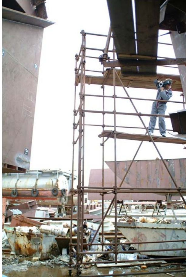
Slika 78: Snimanje sekcije s pomične skele
