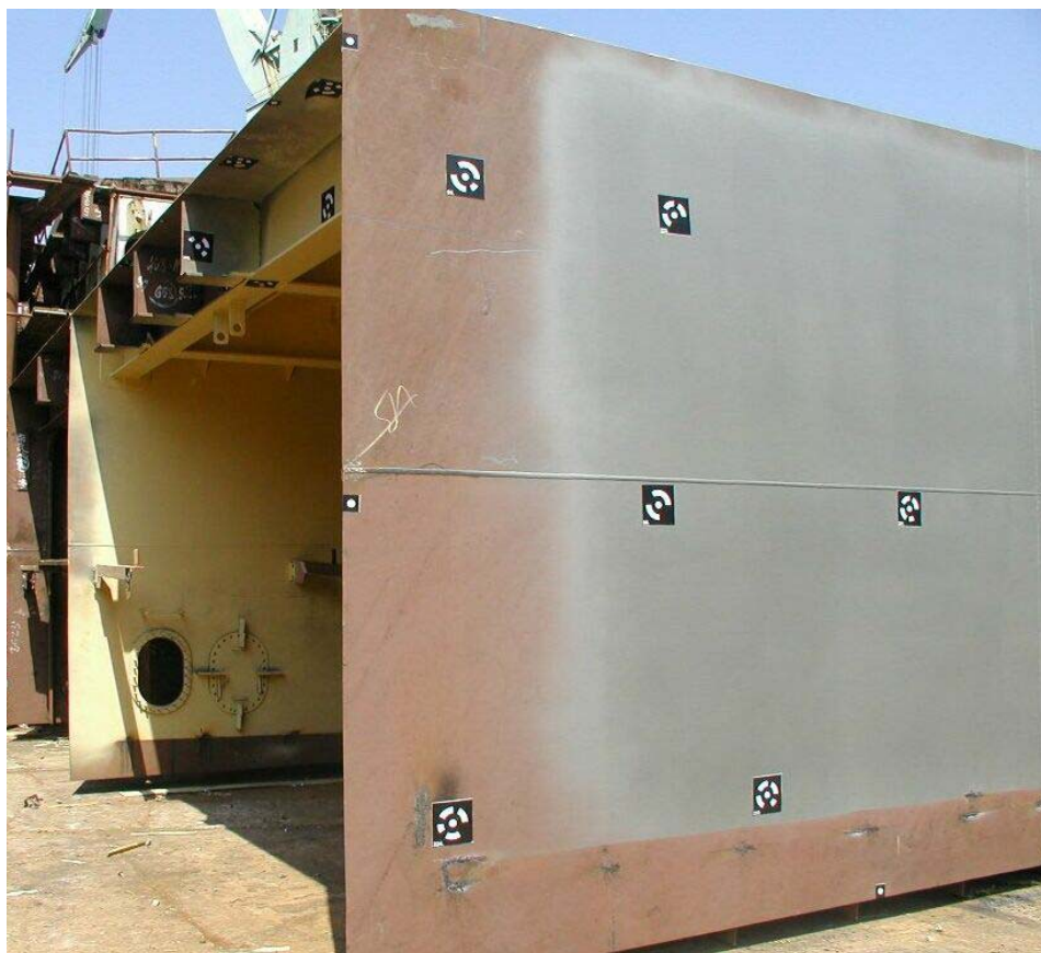
Slika 42: Postavljanje kodiranih i nekodiranih mjernih točaka na mjerni objekt
