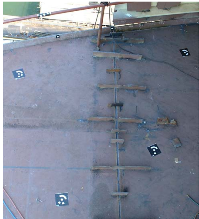
Slika 105: Mjerne točke na sekcijama svjetlog otvora
