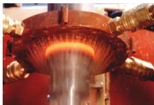
**Slika 2.4** Rotaciono-posmično induksijsko kaljenje osovine uz gašenje prskanjem
