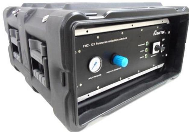
Slika 16. Jedinica za napajanje i upravljanje FMC-121 [11]
