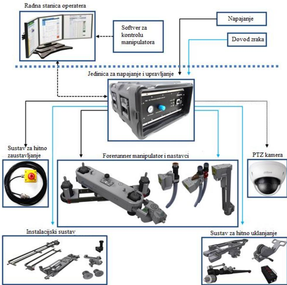
Slika 12. Forerunner inspekcijski sustav tvrtke INETEC za generatore pare nuklearnih elektrana PWR tipa [11]
