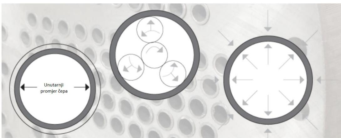
Slika 47. Princip čepljenja tehnikom rolanja [32]
