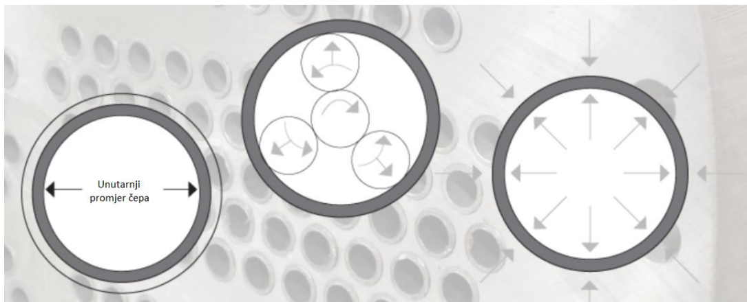
Slika 47. Princip čepljenja tehnikom rolanja [32]
