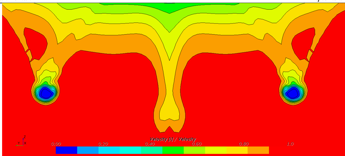
Slika 58. Polje nominalnog sustrujanja u brodskoj vijka (Model 1, RSM)
