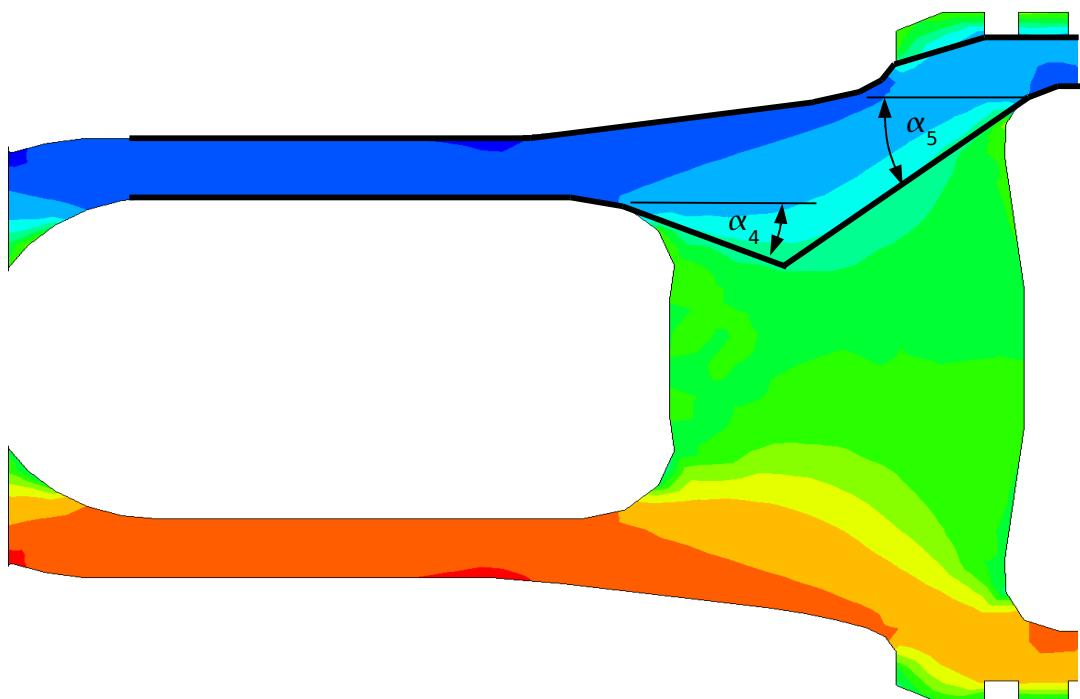
Slika 21. Kontura toka sila na izlazu iz kompresora
