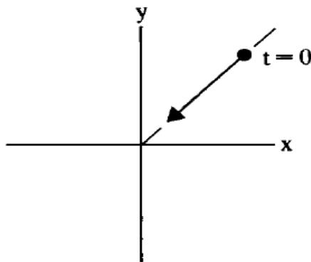
Slika 1. Trajektorija rotora u faznoj ravnini kod nadkritično prigušenih vibracija (monotonu smirujuće gibanje)
