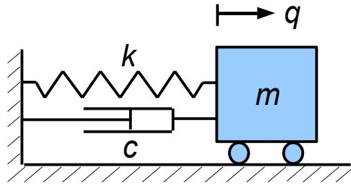
Slika 4. Prigušeni vibracijski sustav s jednim stupnjem slobode gibanja
