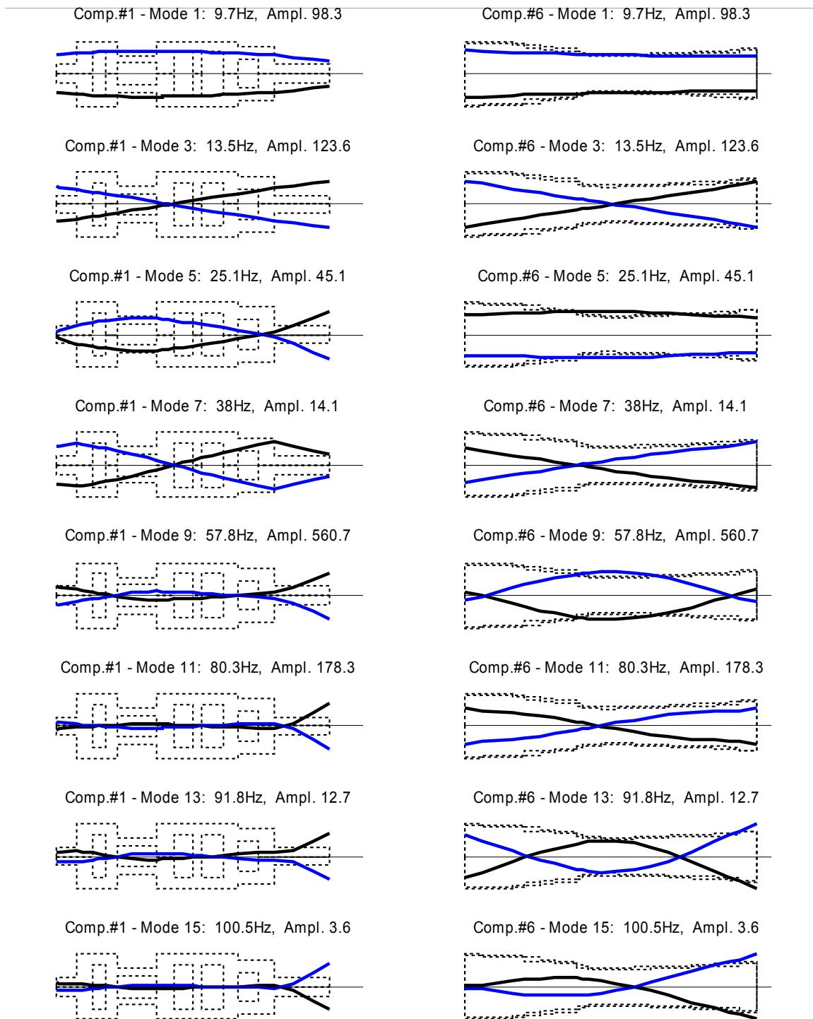
Slika 49. Inženjerski postupak: načini vibriranja optimalnog modela plinske turbine kod radne brzine vrtnje rotora (vibracije protusmjerne vrtnji)
