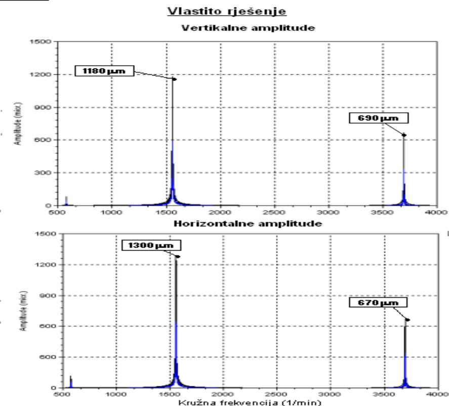
**Primjer 18:****Prisilne vibracije: PRIMJER TURBINSKOG POSTOJENJA****Usporedba amplituda u rezonanciji uslijed neuravnoteženosti rotora**
