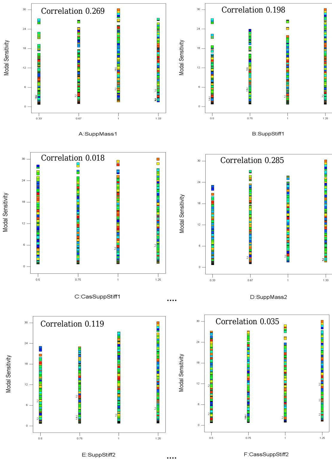
Slika 54. Osjetljivost na neuravnoveženost u ovisnosti o projektnim parametrima
