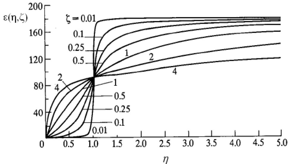
Slika 8. Fazni kut zaostajanja prisilnih vibracija za uzbudom
