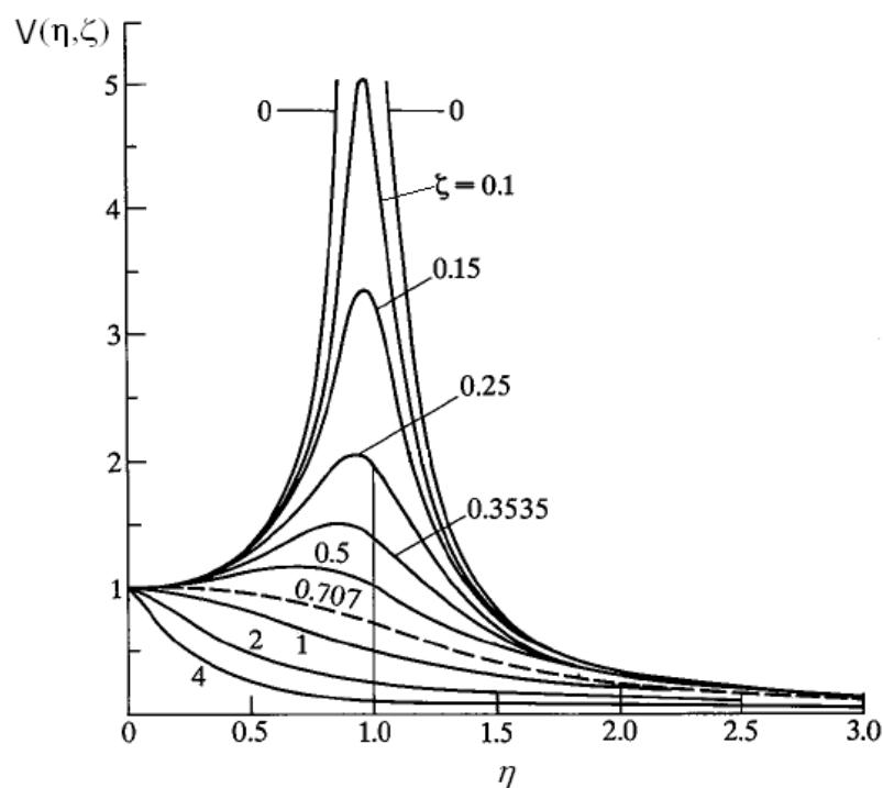
Slika 6. Funkcija povećanja amplitude uslijed harmonijske uzbude
