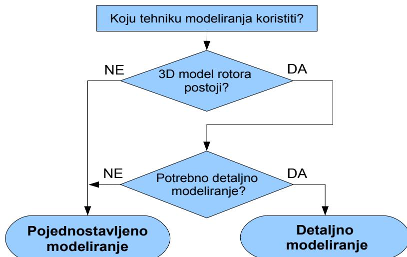
Slika 17. Odabir postupka modeliranja rotora
