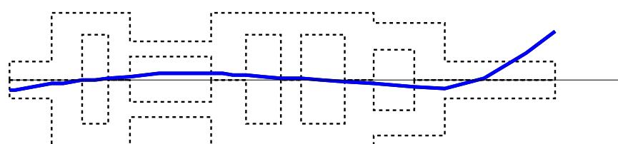
Slika 44. Drugi korak optimiranja: načini vibriranja rotora plinske turbine
