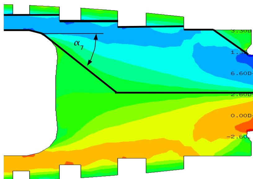
Slika 23. Kontura toka sila na ulazu kompresora
