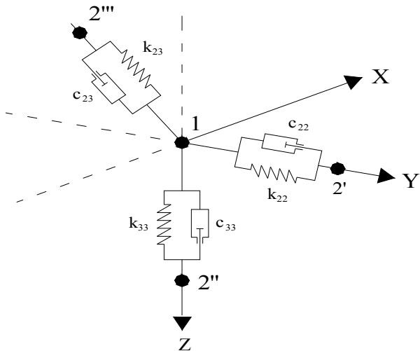
Slika 15. Model radijalnog ležaja
