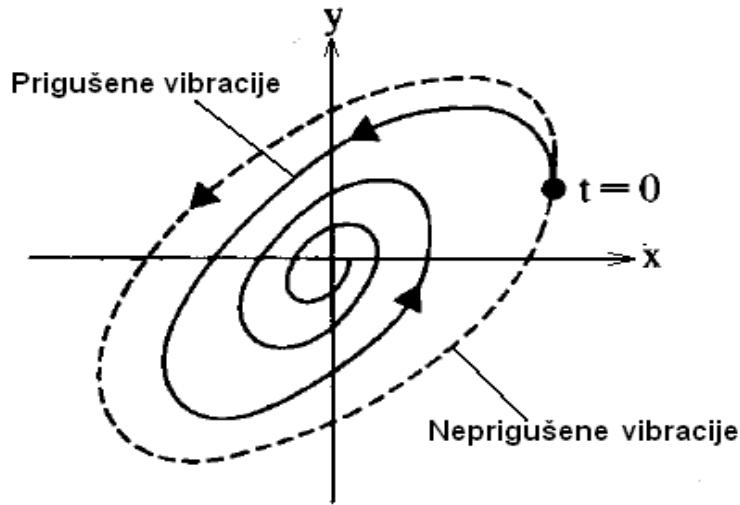
Slika 2. Trajektorije rotora u faznoj ravnini kod podkritično prigušenih i neprigušenih vibracija
