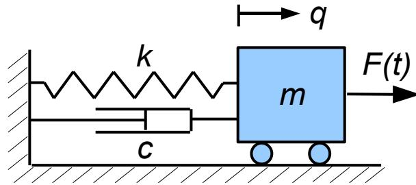
Slika 5. Prigušeni vibracijski sustav s kinetičkom periodičkom uzbudom
