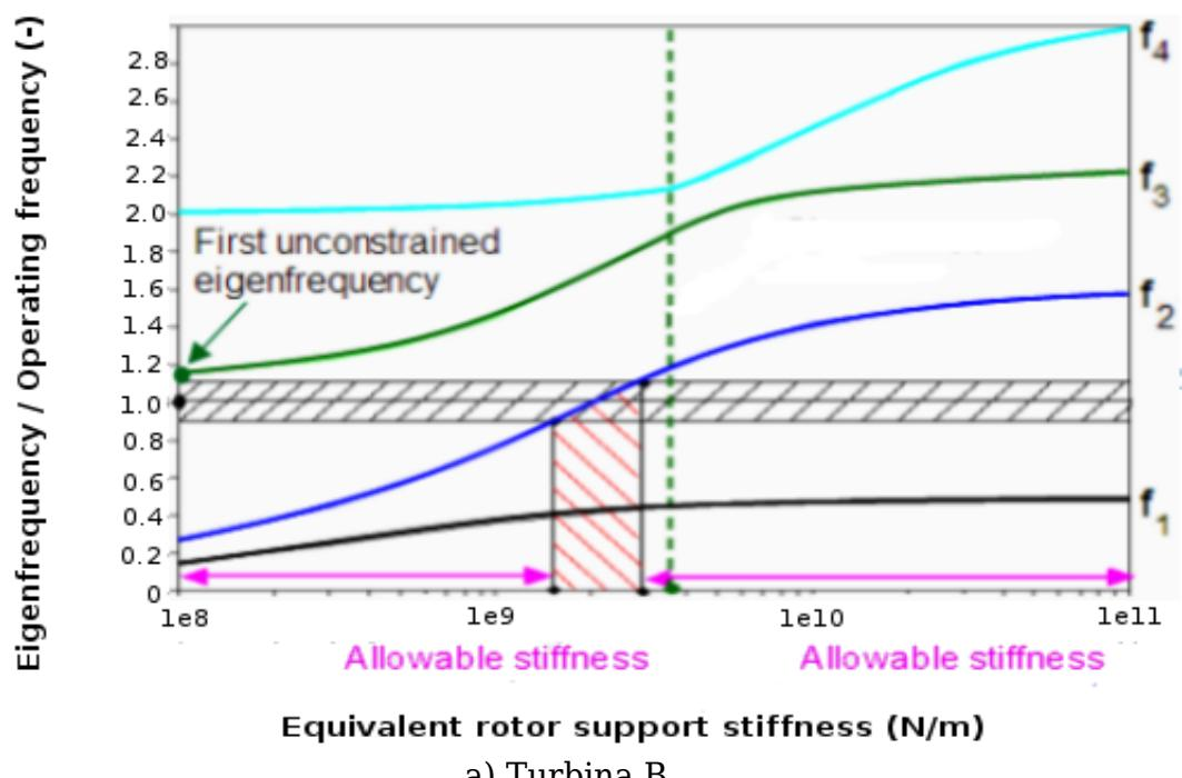
Slika 59. Vlastite frekvencije u ovisnosti o ekvivalentnoj krutosti oslonaca rotora
