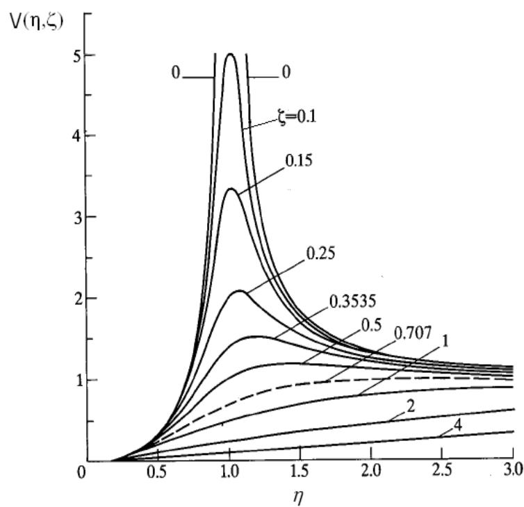
Slika 7. Funkcija povećanja amplitude uslijed neuravnotežene inercijske sile
