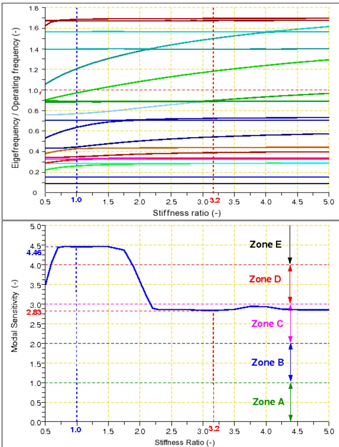
Slika 65. Vlastite frekvencije i osjetljivost na neuravnoveženost plinske turbine u ovisnosti o omjeru krutosti oslonaca
