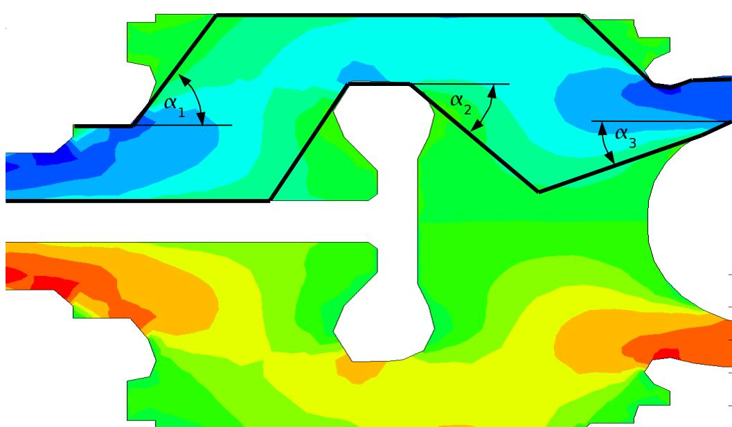
Slika 20. Kontura toka sila u turbinskom dijelu rotora
