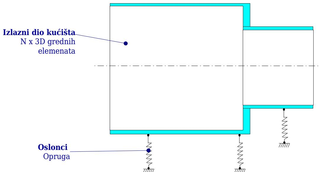
Slika 31. Model izlaznog dijela turbine
