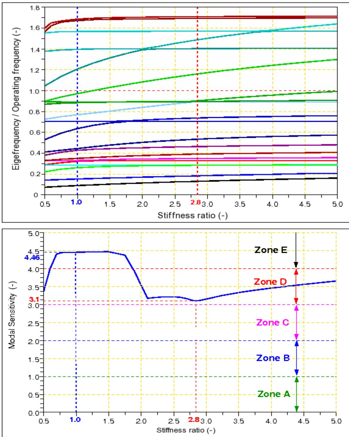
Slika 62. Vlastite frekvencije i osjetljivost na neuravnovezenost plinske turbine u ovisnosti o omjeru krutosti oslonaca
