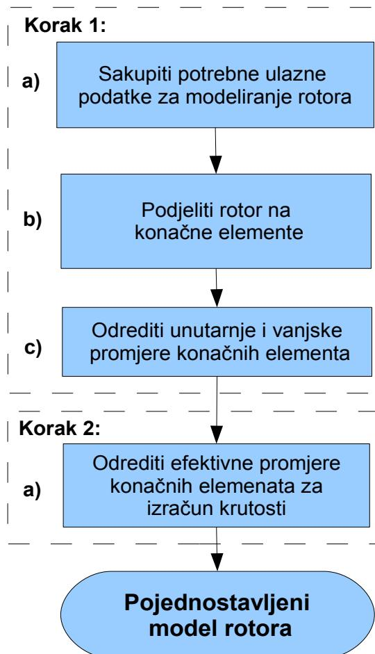
Slika 18. Pojednostavljeno modeliranje rotora plinske turbine
