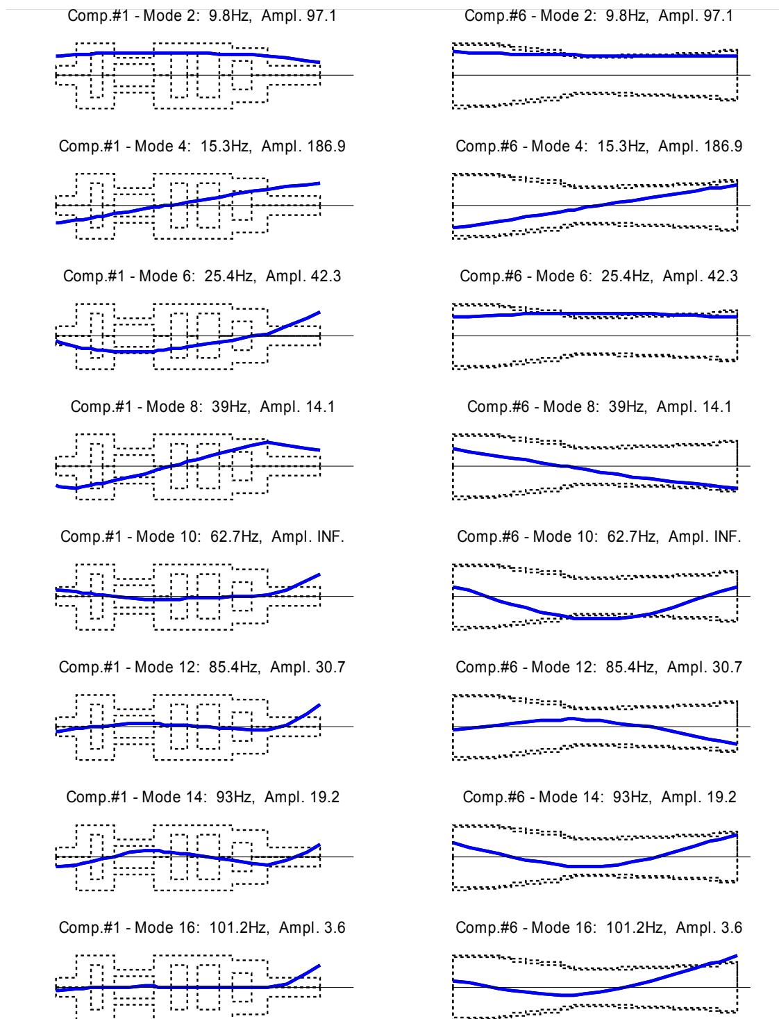
Slika 48. Inženjerski postupak: načini vibriranja optimalnog modela plinske turbine kod radne brzine vrtnje rotora (vibracije istosmjerne vrtnji)
