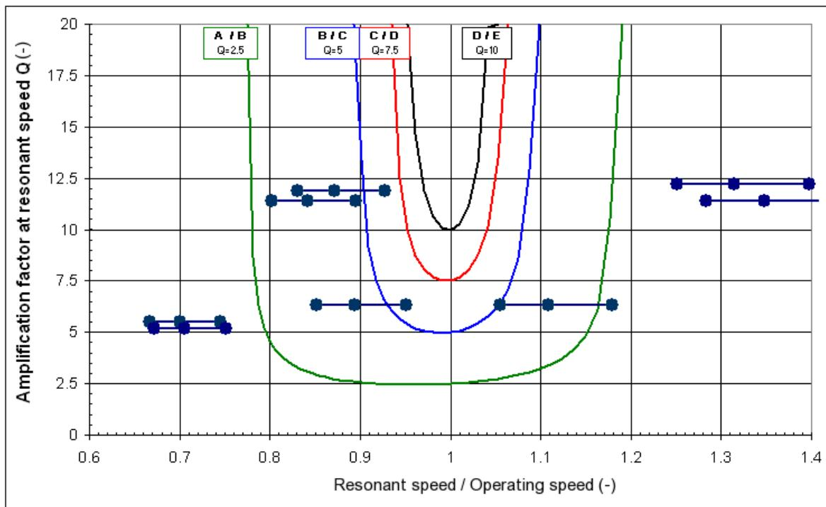
Slika 71. Osjetljivost na neuravnoteženost: optimum dobiven selektivnim pokusom
