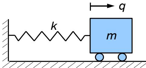
Slika 3. Neprigušeni vibracijski sustav s jednim stupnjem slobode gibanja
