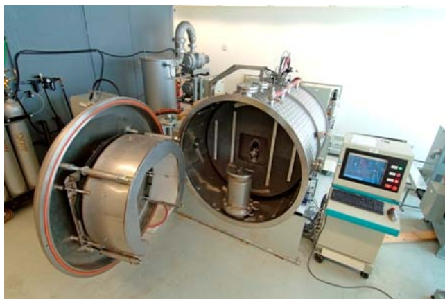
Slika 3.13. Postrojenje za naštrcavanje plazmom u vakuumu, [45]
