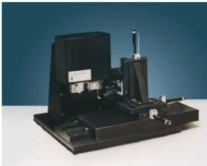
Slika 5.23. Uređaj za ispitivanje nanotvrdoće NanoTest 600 Micro Materials Ltd, [55]
