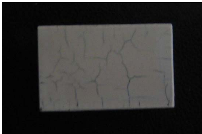
Slika 5.5. Popucala \text{Al}_2\text{O}_3 prevlaka nakon žarenja na 1000^\circ\text{C} na uzorku 3
