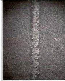
Lc2, Nestaje oranje i počinje odvajanje na rubove traga
